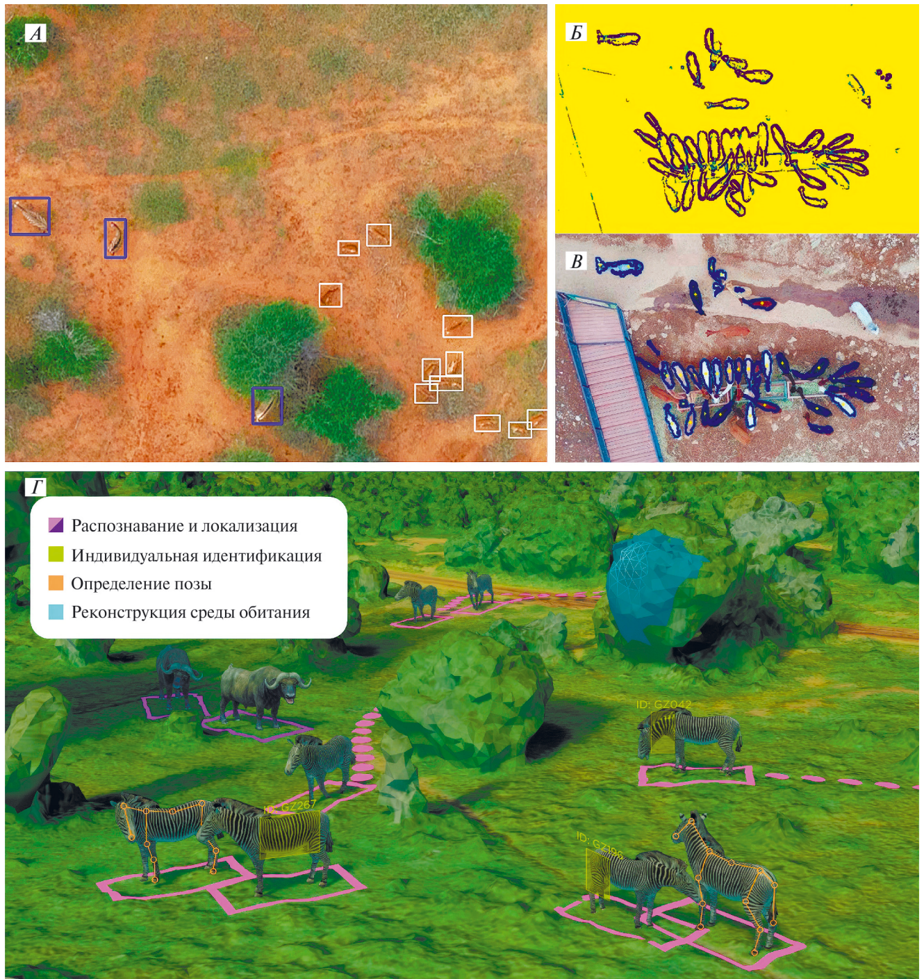
Рис. 3. Использование алгоритмов компьютерного зрения для анализа материалов, полученных с БПЛА. A – одновременное автоматическое определение и трекинг двух видов копытных с визуализированными ограничительными рамками объектов (bbox) для двух видеокadres с использованием обученных моделей (зебры – синий цвет, импалы – белый цвет). Пример автоматической детекции животных на сложном фоне ( B ) с применением функции оператора Собеля для обнаружения границ и ( B ) их отрисовки на исходное изображение. G – Сводная инфографика, демонстрирующая современные возможности использования компьютерного зрения для: распознавания видовой принадлежности млекопитающих их положения в пространстве (фиолетовый цвет), отслеживания их перемещений (розовый цвет), индивидуальной идентификации особей (зеленый цвет), категоризации поз тела (оранжевый цвет), реконструкции местообитаний, в том числе поврежденных (голубой цвет). Иллюстрации находятся под открытой лицензией на повторное использование: A – Koger et al., 2023; B , B – Lee et al., 2021; G – Tuia et al., 2022.
