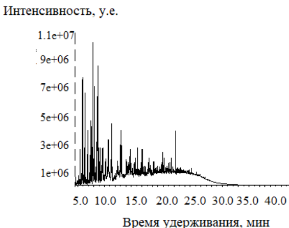
Рис. 4.12. Хроматограмма хлороформного экстракта пиरोлизного масла после экстракции этиленгликолем
