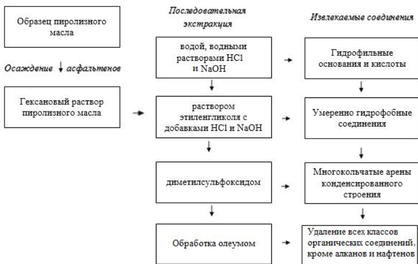
Рис. 4.5. Схема методики последовательной экстракционной пробоподготовки образцов
