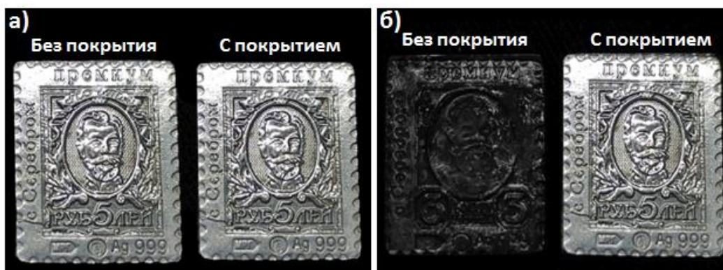
Рисунок 1. Результаты выдержки серебряных монет с защитным покрытием и без в агрессивной среде. (а) до погружения в раствор серы, (б) после выдержки в растворе серы.
