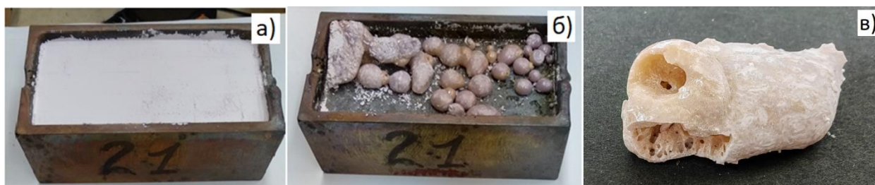
Рисунок 1. Синтез высокоэнтропийной керамики в мощном пучке быстрых электронов: а) - исходная порошковая смесь оксидов; б) и в) – синтезированный керамический продукт (Y_{0.2}Yb_{0.2}Lu_{0.2}Eu_{0.2}Er_{0.2})_3Al_5O_{12} в кювете и его фрагмент соответственно.
