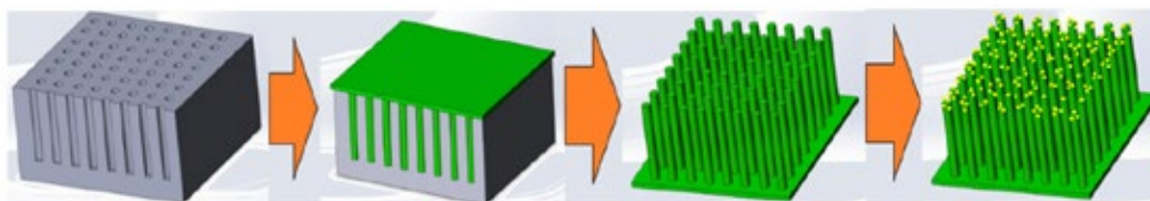
Рисунок 1. Принципиальная схема получения никелево-палладиевого катализатора
