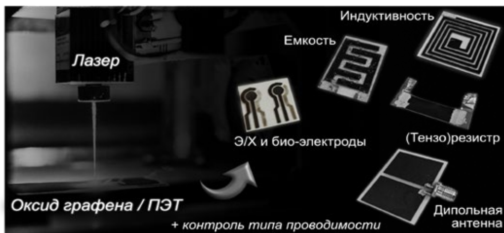
Рисунок 1. Базовые компоненты гибких электронных схем, изготовленных из восстановленного ОГ.
