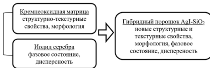
Рисунок 1. Свойства исходных компонентов гибрида и характеристические особенности синтезированного гибрида
