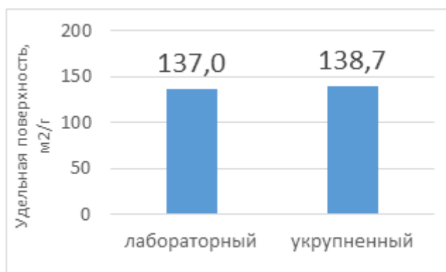
Рисунок 1. Результаты измерений удельной поверхности для лабораторного и укрупненного образцов
