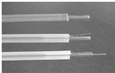
Рис. 2. Волоконные датчики температуры и деформации
