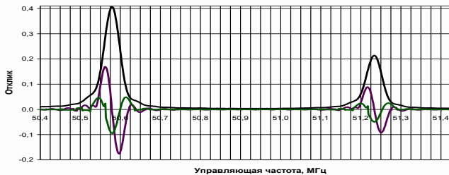
Рис. 2. Часть спектра, зарегистрированная созданным макетом
