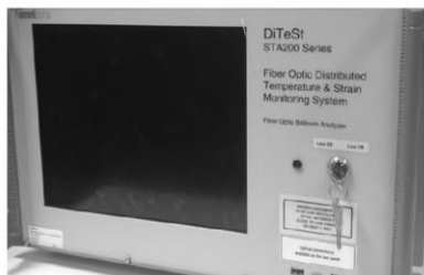
Рис. 1. Оптоэлектронный датчик распределенной сенсорной системы Бриллюэна
