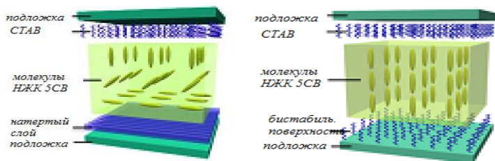
Рис. 1. Схема геометрии ячейки с гибридной (слева) и гомеотропной (справа) ориентации
