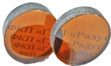
Рис. 2. Образец высокопрозрачная композитная лазерная керамика (ВПКЛК) Nd:YAG/Cr:YAG
