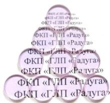
Рис. 1. Образец высокопрозрачной лазерной нанокерамики (ВПЛК)
