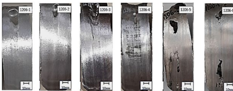
Рисунок 1. Темплеты слитков стали Fe-13Cr-(N, Mn, Mo, V, Nb) при определении K_y
