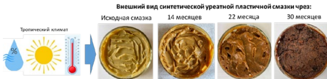
Рисунок. Изменение внешнего вида уреатной пластичной смазки при экспонировании в условиях тропического климата
