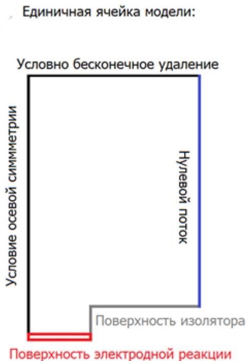
Рисунок 22. Геометрическая схема углубленных ультрамикроэлектродов.
