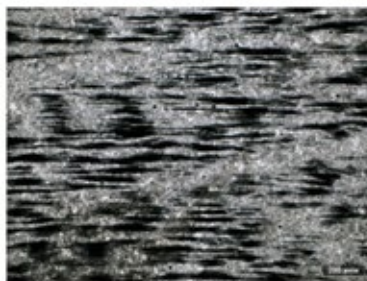
Рисунок 1. Вид деформированной дендритной структуры
