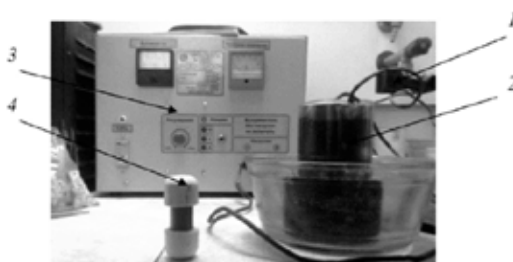
Рисунок 1. Сборка стенда электрохимического травления: 1 – зажим; 2 – стеклянный стакан со стальной лентой; 3 – выпрямитель, 4 – подготовленный образец
