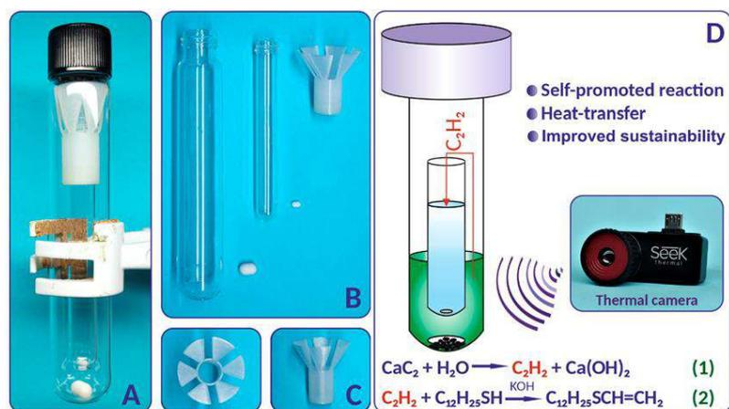
Рисунок 1 – Реакционная установка с использованием разработанного реактора типа «пробирка в пробирке»: А – готовый к использованию реактор; В – реактор в разобранном виде; С – нейлоновый вкладыш; D – тепловизионная камера и схема реактора «пробирка в пробирке» и две ступенчатые химические реакции
