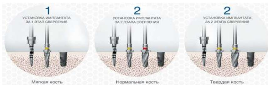
Рисунок 2. Установка импланта в кость
