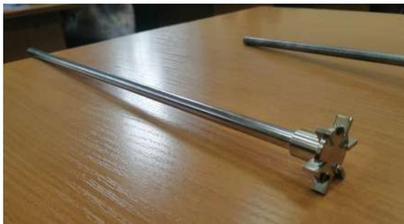
Рисунок 1. Фотография мешалки, изготовленной на 3D-принтере
