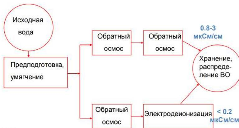
Рисунок. Блок-схема водоподготовки на фармацевтическом предприятии
