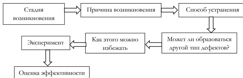
Рисунок. Схема риск-ориентированного подхода разработки технологических режимов нанесения пленочного покрытия
