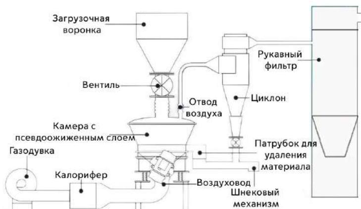
Рисунок 1. Схема сушилки с псевдооживленным слоем
