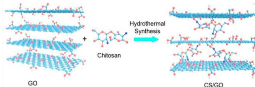
Рисунок 5. Схема механизма получения аэрогеля хитозана с оксидом графена гидротермальным методом
