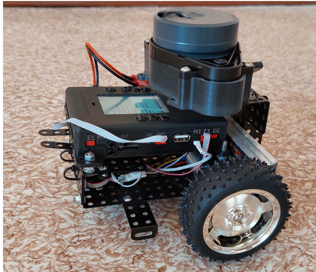
Рис. 1. Робот «ТРИК» [4] с установленным датчиком LIDAR.
