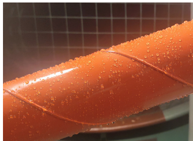
Рис. 2. Фотография модели ванты при совместном исследовании влияния дождя и ветра.
