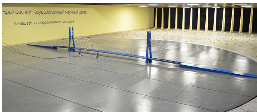
Рис. 3. Фотография полной динамически подобной модели вантового моста в рабочей части Ландшафтной аэродинамической трубы.
