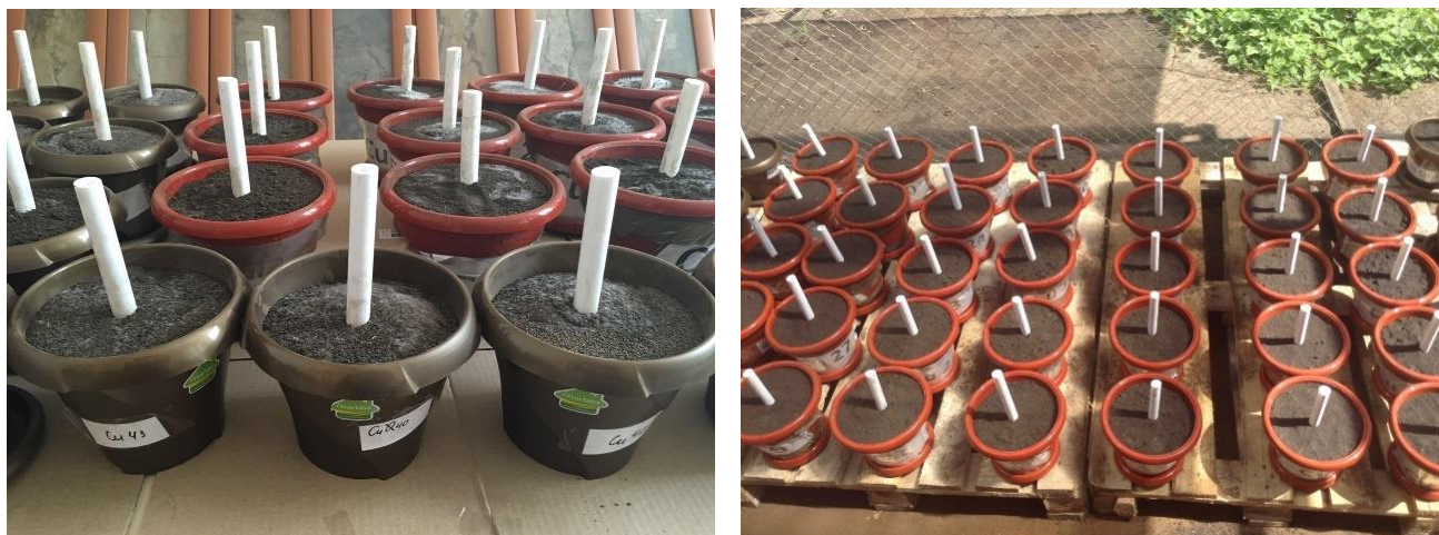
Рис. 1. Закладка многофакторного модельного опыта с каштановой слабосолонцеватой и солонцом каштановым, загрязненных БаП (400-1200 мкг/кг) и CuO (300-10000 мг/кг) при внесении биочара из шелухи риса отдельно и в сочетании с фосфогипсом и бактериями ПАУ-деструкторами
