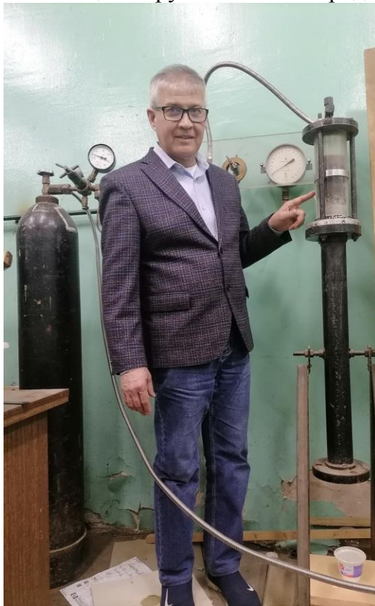
Рис. 1. Лабораторная установка для определения параметров водоизолирующего слоя
