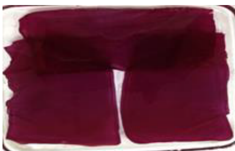
Рис 1. Смешанные мембраны целлюлоза/соевый протеин, окрашенные в кислотном красном 337 и прямом голубом 160 красителях.
