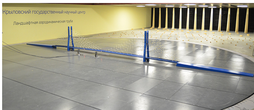
Рис. 3. Фотография полной динамически подобной модели вантового моста в рабочей части Ландшафтной аэродинамической трубы.
