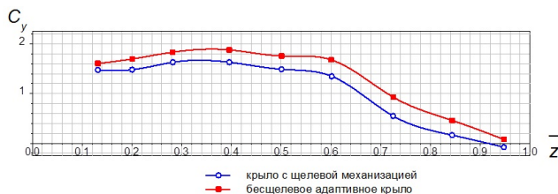
Рис. 3. Распределение коэффициента подъемной силы в сечениях крыла, AoA = 2^\circ .
