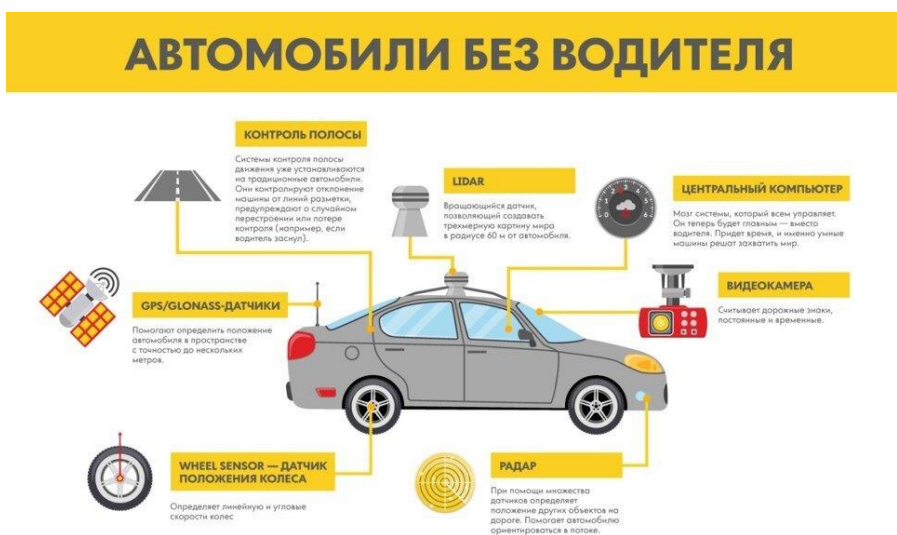
Устройства и датчики в беспилотном автомобиле
