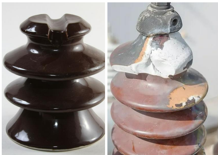
Рис. 2. Изображение изоляторов (слева полностью рабочий, справа с дефектом)
