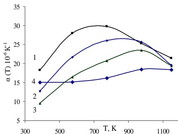
**Рисунок.** Зависимость КТР от температуры ряда твердых растворов  $\text{NdCo}_{1-x}\text{Fe}_x\text{O}_3$ :
