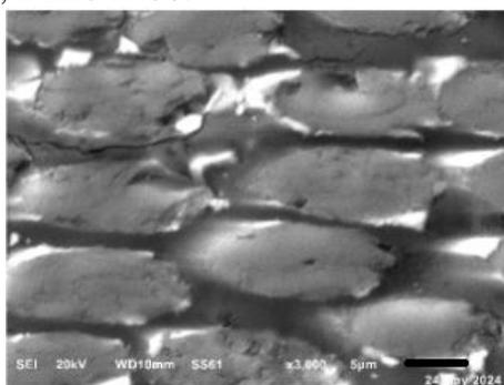
Рисунок 1. Микроструктура композиционного материала с матрицей оксида циркония
