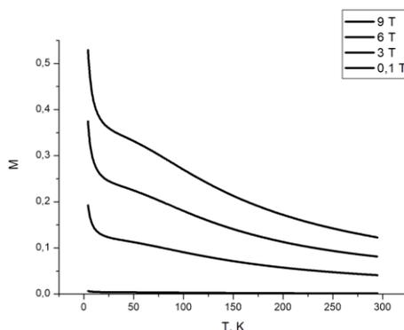
**Рисунок 1.** Полевая зависимость намагниченности выращенных кристаллов  $\text{NdGa}_3(\text{VO}_3)_4$ .
