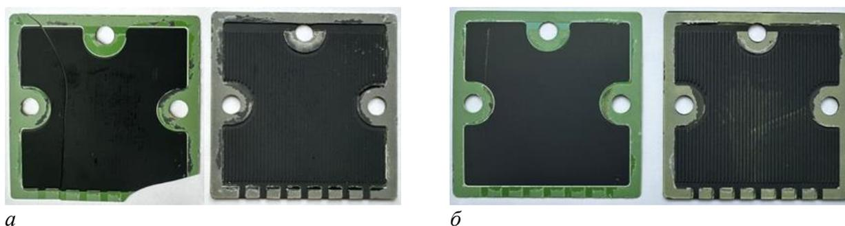
Рисунок 2. Единичный топливный элемент после проверки на герметичность
