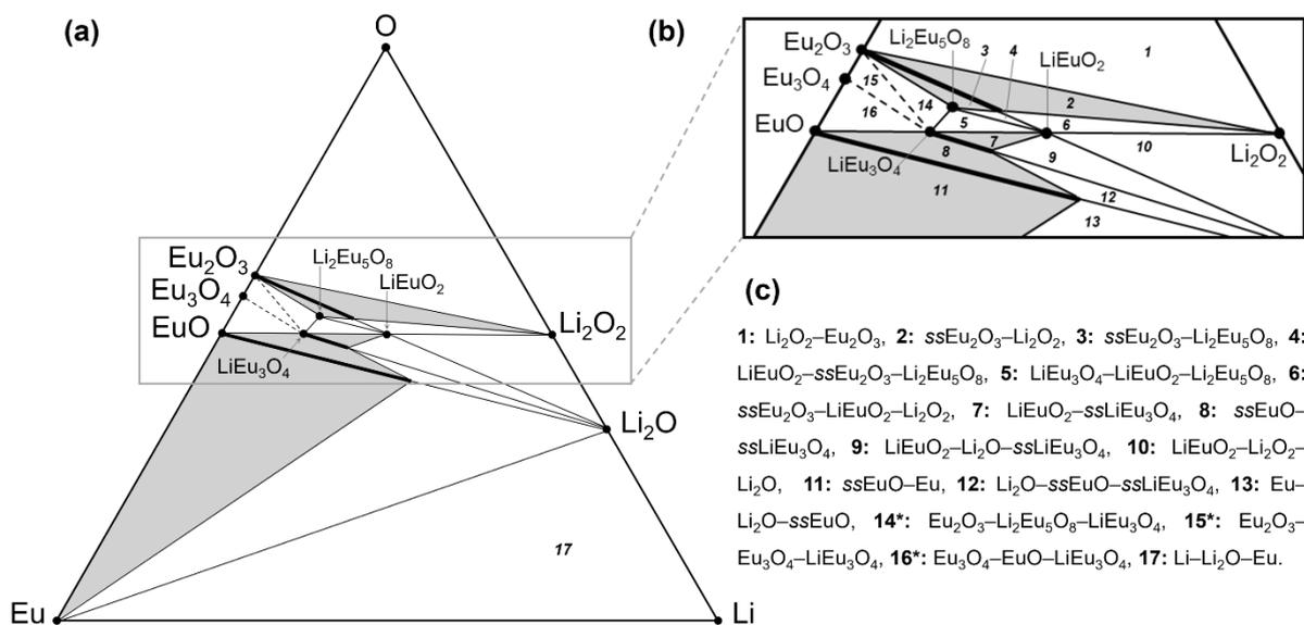
**Рисунок 1.**  $x$ - $y$ -Проекция  $P$ - $T$ - $x$ - $y$ -фазовой диаграммы системы Li–Eu–O (a), её фрагмент, демонстрирующий равновесия с участием твёрдых растворов (b) и отнесение соответствующих областей двух- и трёхфазным равновесиям (c), \*-гипотетические равновесия, не наблюдавшиеся экспериментально; ss- твёрдый раствор.
