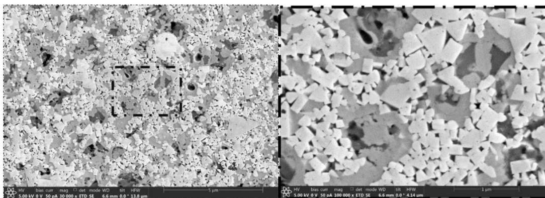
Рисунок 1. Микроструктура сплава Т15К6 спеченного при температуре 1150°С
