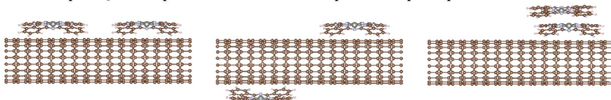
**Рисунок 1.** Строение суперячейки УНТ(10,0), состоящей из 8-и элементарных ячеек вдоль направления периодичности углеродной нанотрубки, с различным расположением двух молекул фталоцианина цинка на поверхности
