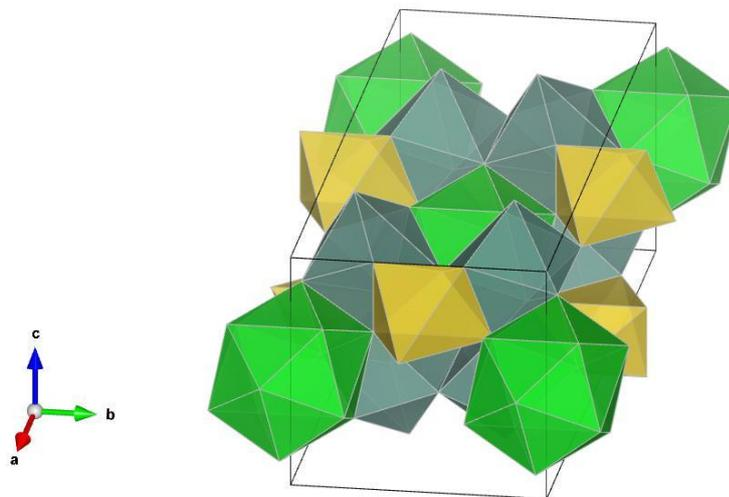
Рисунок 1. Кристаллическая структура Na<sub>2</sub>BaY<sub>4</sub>F<sub>16</sub>
