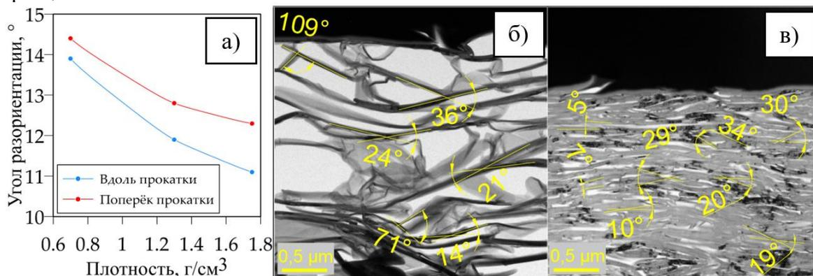
**Рисунок 1.** а) Зависимость углов разориентации микрокристаллитов ГФ от её плотности; ПЭМ изображения с обозначенными углами разориентации между частицами ТРГ для плотностей б) 0,70 г/см<sup>3</sup>; в) 1,75 г/см<sup>3</sup>.
