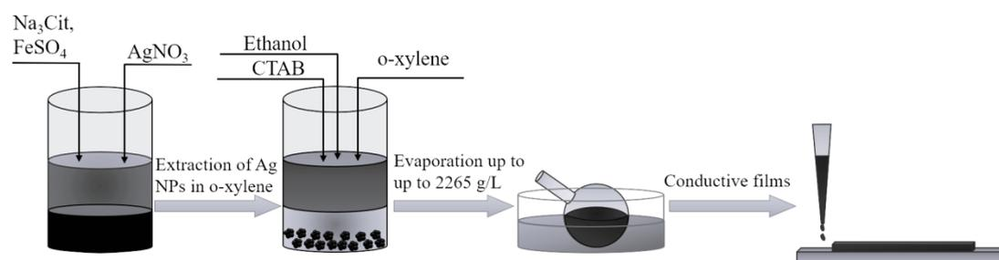
**Рисунок 1.** Принципиальная схема получения ультра концентрированных органозолой серебра
