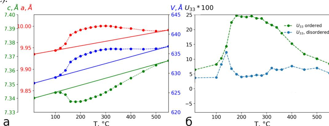
**Рисунок 1.** Зависимость от температуры параметров решётки  $\text{RbLa}_9\text{Ge}_6\text{O}_{26}$  (а) и тепловых колебаний кислорода O(4) вдоль оси  $c$  в упорядоченной и разупорядоченной модели (б).
