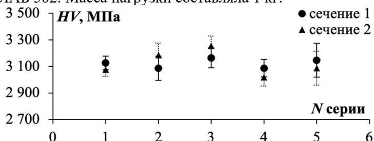
Рисунок 1. Твёрдость образцов ТВС в различных сечениях
