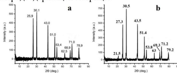
**Рисунок 1.** Профиль РФА продуктов термолиза циннамата свинца (а) и комплекса циннамат свинца-1,10-фенантролин (б).
