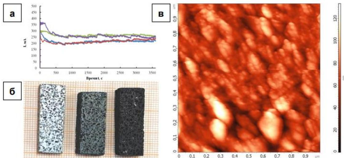
**Рисунок 1.** Зависимости  $I(t)$ , полученные при анодировании ПА в 15%  $H_2SO_4$  при 10В – (а); фотография образцов на разных стадиях модификации – (б); АСМ-изображение поверхности ПА после анодирования и ЭХО модификации наночастицами Ag – (в)
