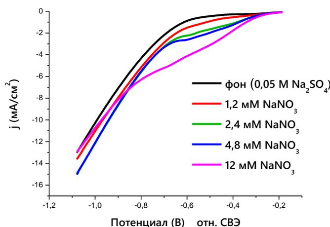
**Рисунок 1.** Потенциодинамические кривые, полученные в нейтральном растворе 0,05M Na<sub>2</sub>SO<sub>4</sub> при скорости развертки потенциала 50 мВ/с в отсутствии и присутствии нитрат-ионов (концентрации: 1,2 – 12 mM) для электрокатализатора Co-Cu (75:25).
