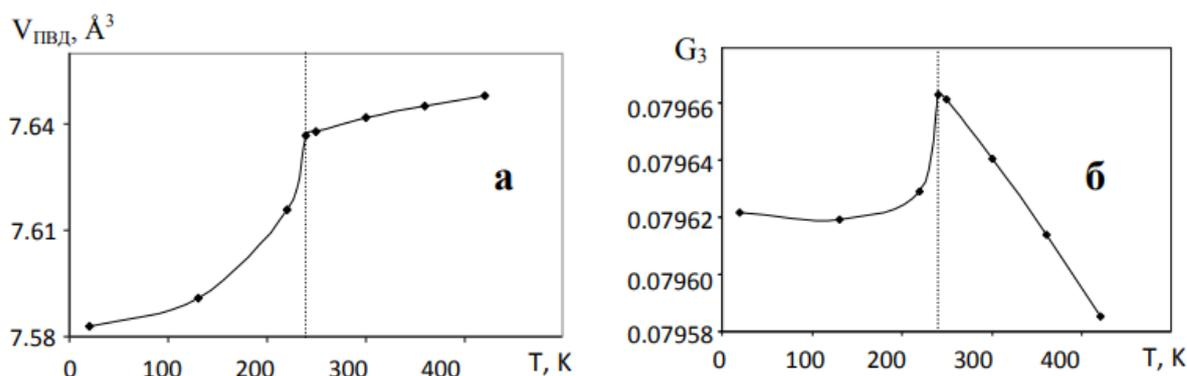
**Рисунок 1.** Зависимость от температуры объема полиэдра ВД атомов Mn (а) и  $G_3$  полиэдров ВД атомов Ca (б) в структуре  $\text{La}_{0.75}\text{Ca}_{0.25}\text{MnO}_3$ . Вертикальная пунктирная линия отвечает  $T_{\text{C}} = T_{\text{M-I}} = 240$  К.
