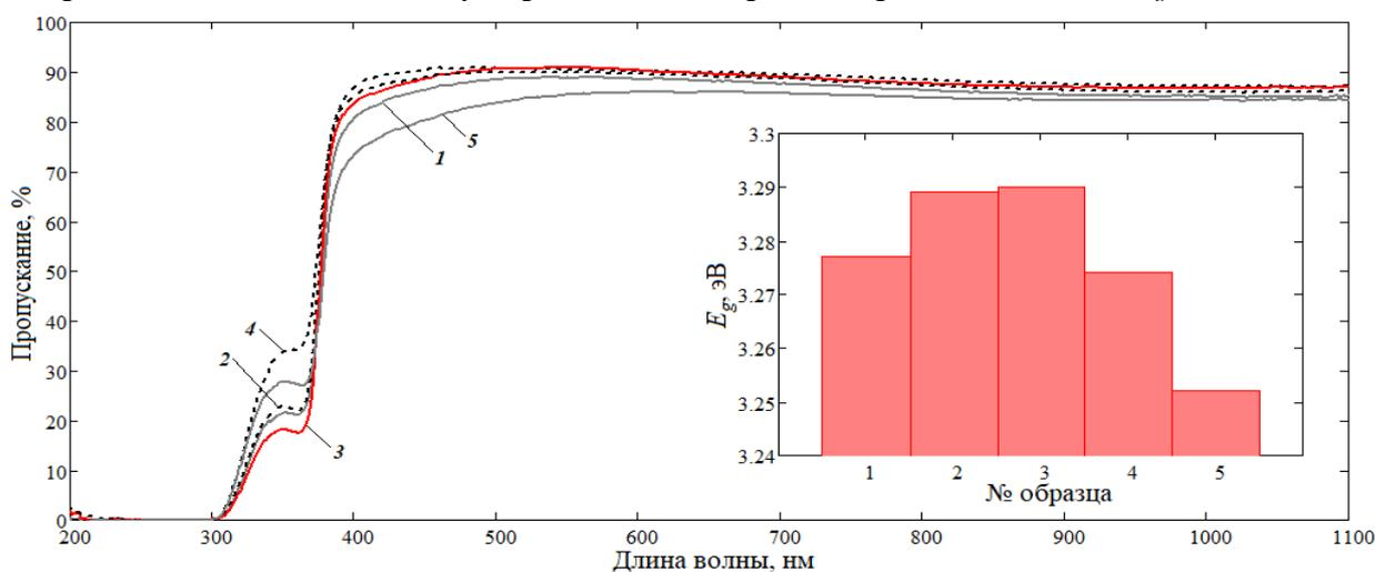
**Рисунок 1.** Оптические характеристики тонких пленок ZnO, синтезированных на основе комбинированных золь-гель с различным временем созревания: 1 – 1 ч; 2 – 1 ч +24 ч в объемном соотношении 2:1; 3 – 1 ч +24 ч в объемном соотношении 1:1; 4 – 1 ч +24 ч в объемном соотношении 1:2; 5 – 24 ч
