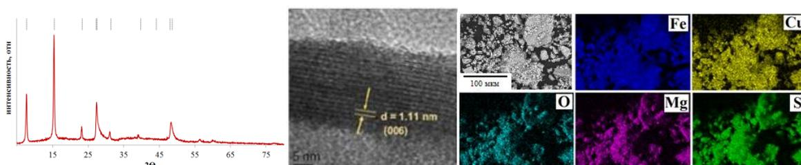
Рисунок 1. Результаты анализа типичного материала (валлериит): РФА, ПЭМ, СЭМ-PCMA
