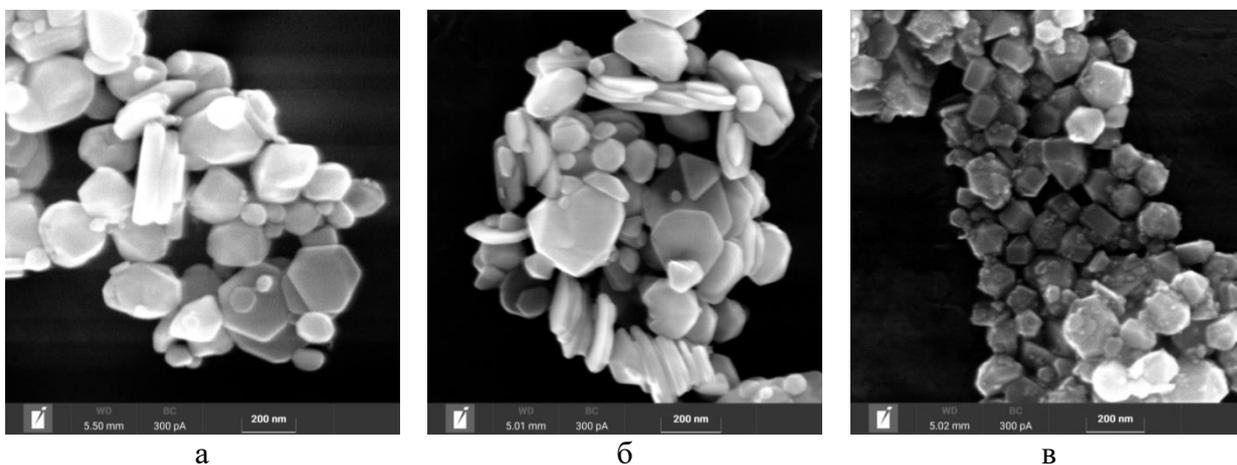
**Рисунок 1.** Рисунок 1. СЭМ полученных нанопластин Ag
