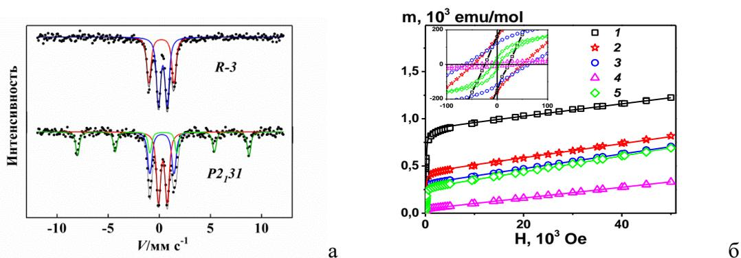
**Рисунок 1.** (а) Мессбауэровский спектр  $Y_2FeTaO_7$  (верхний) и  $Y_{1.8}Fe_{1.2}TaO_7$  (нижний) при 300 К. (б) Полевые зависимости намагниченности при 300 К: 1- $Y_2Mg_{0.3}Fe_{0.7}TaO_7$ , 2- $Y_{1.85}Mg_{0.15}FeTaO_7$ , 3- $Y_{1.85}Mg_{0.15}Fe_{0.925}Ta_{1.075}O_7$ , 4- $Y_2Mg_{0.3}Fe_{0.55}Ta_{1.15}O_7$ , 5- $Y_{1.975}Ca_{0.025}FeTaO_7$ .
