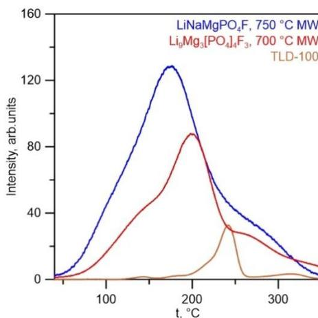
Рисунок 1. Кривые термолюминесценции для  $\text{LiNaMgPO}_4\text{F}$ ,  $\text{Li}_9\text{Mg}_3[\text{PO}_4]_4\text{F}_3$  и TLD-100
