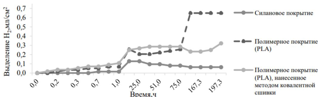
**Рисунок 1.** Количество выделившегося водорода в ходе коррозионных испытаний в течение 8 суток в растворе Хенкса
