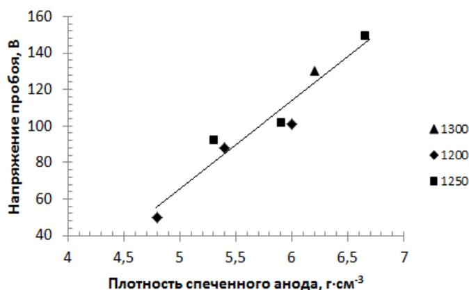
Рисунок 1. Зависимость напряжения пробоя от плотности спеченного анода
