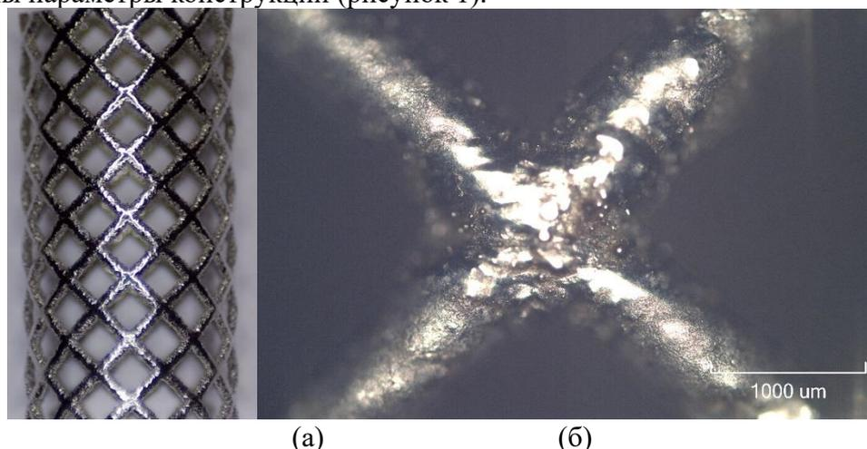
**Рисунок 1.** Сетчатая конструкция (а), перемычки стента (б)
