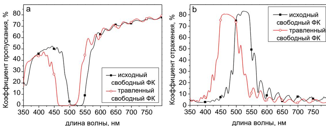
**Рисунок 1.** Спектры пропускания (а) и отражения (б) свободных от подложек образцов ФК АОА, сформированных в электролите с 50 об.% этиленгликоля и величине плотности заряда периода 0,44 Кл/см<sup>2</sup>
