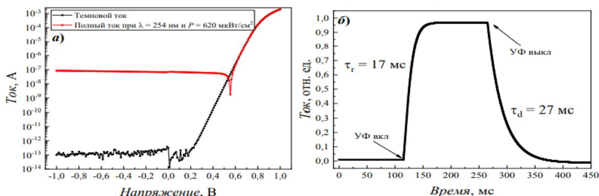
**Рисунок 1.** Вольт-амперные характеристики ДБШ Pt/ $\beta$ -Ga<sub>2</sub>O<sub>3</sub> и временной профиль тока (б) при воздействии излучения с  $\lambda = 254$  нм
