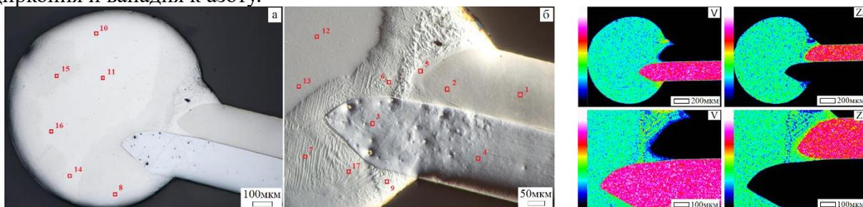
Рисунок 1. Оптическое изображение поверхности шлифа металлического сая и карта распределения концентраций элементов по поверхности образца.
