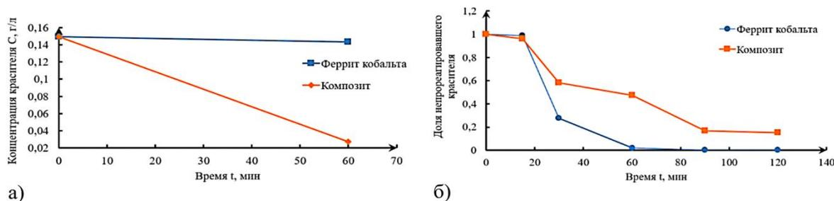
Рисунок 1. Кинетические кривые: а) процесса сорбции ДНФ; б) процесса фотокаталитического окисления ДНФ перекисью водорода
