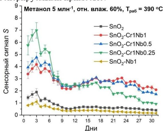
Рисунок 1. Изменение сенсорного сигнала в процессе длительного эксперимента.
