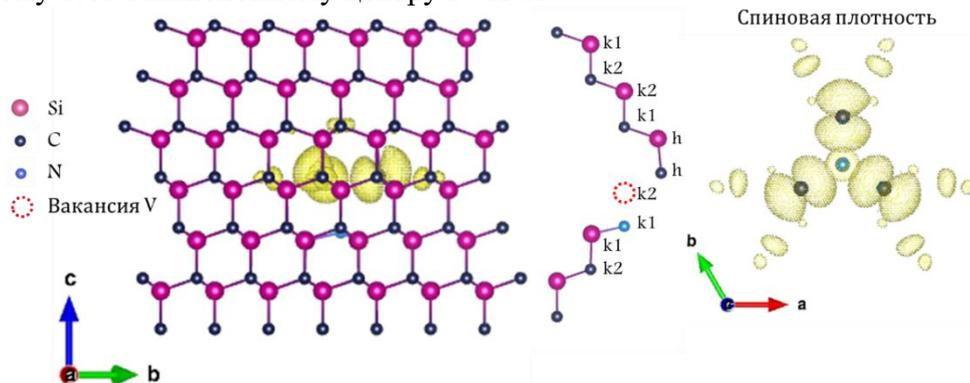
Рисунок 1. Модель NV-дефекта в 6H-SiC в позиции k2k1 и рассчитанная спиновая плотность
