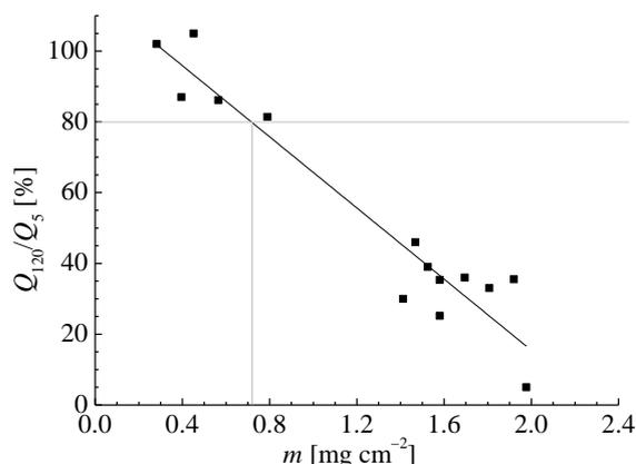
**Рисунок 1.** Нормированное изменение емкости, характеризующее скорость деградации электродов Si/PANI разной толщины (Отношение емкости на 120 цикле к емкости 5 цикла  $Q_{120}/Q_5$  в зависимости от полной намазной массы композита на единицу площади анода). Плотность тока циклирования 300 mA g<sup>-1</sup>.
