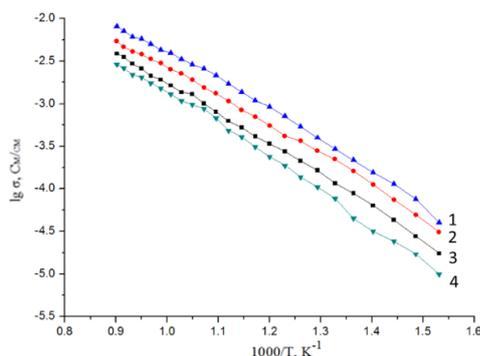
**Рисунок 1** - Температурные зависимости удельной электропроводности керамики состава:  $(\text{CeO}_2)_{1-x}(\text{Dy}_2\text{O}_3)_x$   $x = 0,15(1); 0,10(2); 0,05(3); 0,20(4)$  с добавкой  $3\%$   $\text{ZnO}$
