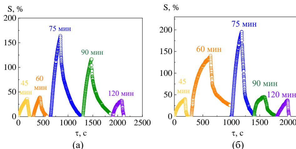
**Рисунок 1.** Кинетическая зависимость величины отклика  $S$  плёнок  $CdS-PbS$ , полученных с использованием 0.08 моль/л (а) и 0.10 моль/л (б)  $CdCl_2$  при варьировании времени осаждения от 45 до 120 мин. Концентрации аммиака в воздушной среде – 1120 ppm ( $800 \text{ мг/м}^3$ ), температура измерений –  $25^\circ C$ .
