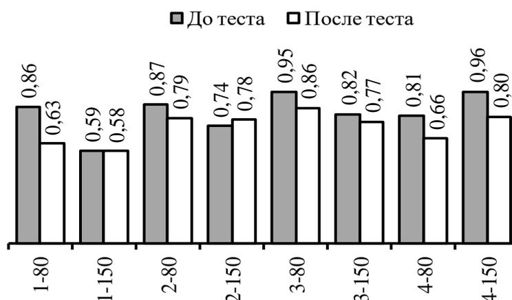
**Рисунок 1.** Изменение постоянной  $a$  уравнения Тафеля: первая цифра – состав раствора, вторая – плотность тока.
