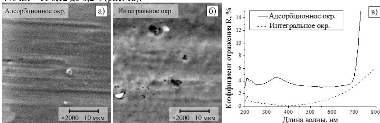
Рисунок 1. РЭМ-изображения покрытий полученных адсорбционным (а) и интегральным окрашиванием (б), и спектры их зеркального отражения (в)
