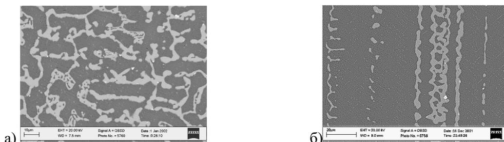
**Рисунок 1.** Микроструктура сплава состава  $\text{Co}_{84,9}\text{Nb}_{6,5}\text{Re}_{6,5}\text{Hf}_{2,1}$  (ат. %) после отжига при 1375 К в течение 48 ч (а), после старения при 1200 К в течение 24 ч (б).
