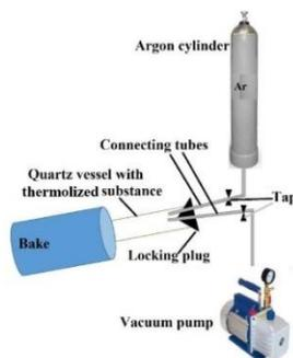
**Рисунок 1.** Схема установки для проведения твердофазного термолиза
