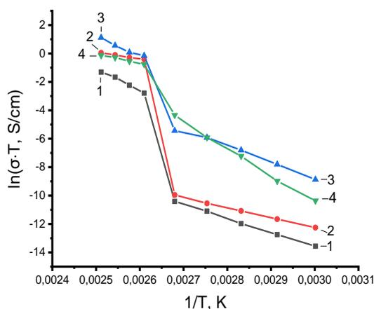
**Рисунок 1.** Температурная зависимость УИП эвтектики LKN (1) и тройных солевых систем:  $0.9\text{(LKN)}\text{--}0.1\text{LiClO}_4$  (2),  $0.8\text{(LKN)}\text{--}0.2\text{LiClO}_4$  (3) и  $0.7\text{(LKN)}\text{--}0.3\text{LiClO}_4$  (4)
