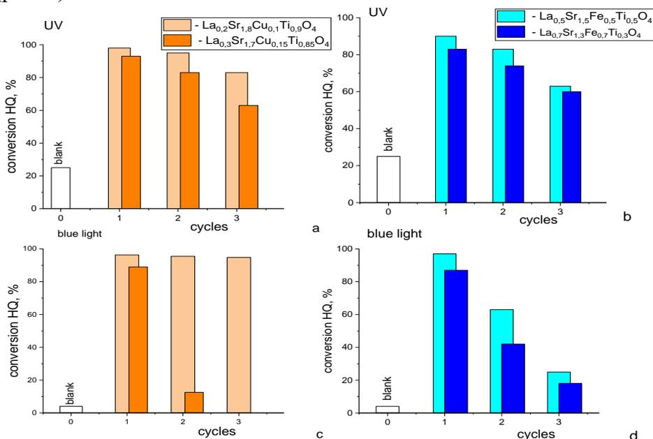
**Рисунок 1.** Степень конверсии ГХ без катализатора (blank) и с использованием катализатора  $\text{La}_x\text{Sr}_{2-x}\text{Ti}_{1-x}\text{M}_x\text{O}_4$  в зависимости от типа облучения и цикла в течение 8 ч
