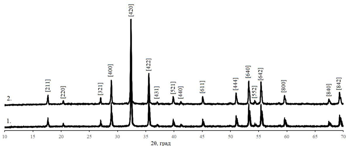
Рисунок 1. Данные РФА для ферритграната составов  $\text{Y}_{2.15}\text{Ce}_{0.15}\text{Bi}_{0.7}\text{Fe}_{3.5}\text{Ga}_{1.5}\text{O}_{12}$  (1) и  $\text{Y}_{1.85}\text{Ce}_{0.15}\text{Bi}\text{Fe}_{3.5}\text{Ga}_{1.5}\text{O}_{12}$  (2).
