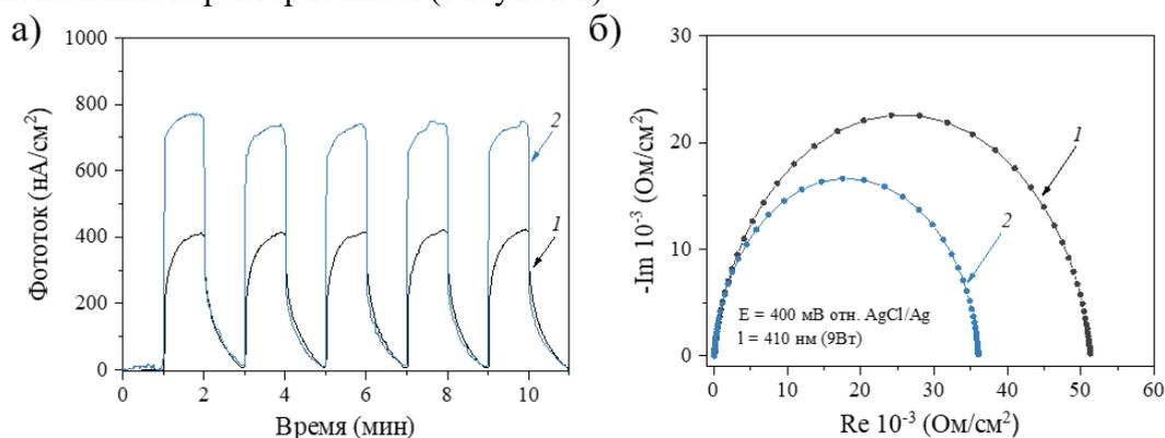
**Рисунок 1.** Результаты фотогальванического отклика и спектры импеданса в координатах Найквиста для  $\text{PrFeO}_3$ , полученного в присутствии 1-0%  $g\text{-C}_3\text{N}_4$  и 2-40%  $g\text{-C}_3\text{N}_4$ .
