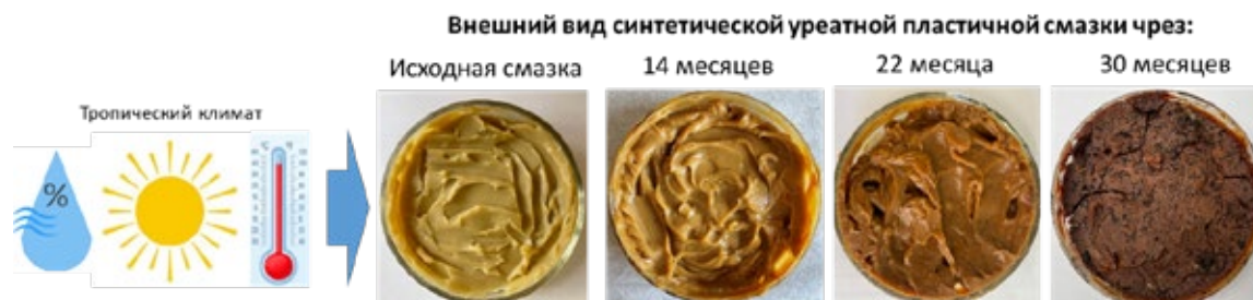
Рисунок. Изменение внешнего вида уреатной пластичной смазки при экспонировании в условиях тропического климата
