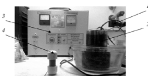
Рисунок 1. Сборка стенда электрохимического травливания: 1 – зажим; 2 – стеклянный стакан со стальной лентой; 3 – выпрямитель, 4 – подготовленный образец
