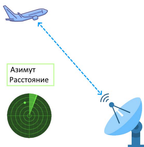
Рисунок 1 – Упрощённый принцип работы первичного радиолокатора
