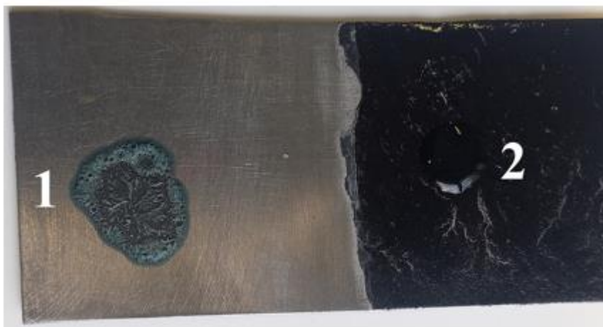
Рисунок 1. Испытание к стойкости к кислотам стальной подложки (1) и покрытия на основе МГ (2)
