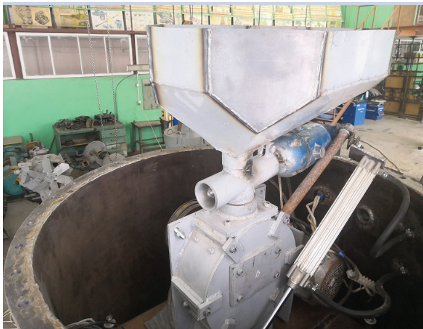
Рис. 2. Общий вид дробилки, установленной в барокамере
