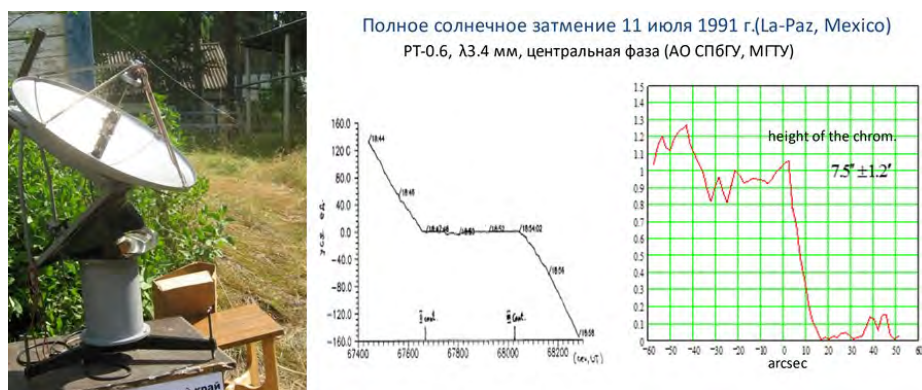
Рис. 2. Пример наблюдения на РТ-0.6 МГТУ солнечного затмения на мм волнах [2].
