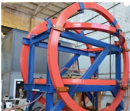
Рис. 1. Испытательная магнитная система с исследуемым оборудованием
