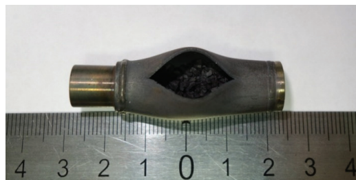
Рис. 2. Ампула с \varepsilon\text{-HfH}_x после испытаний при 900 °C
