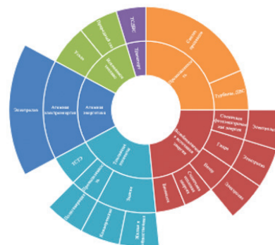
Рис. 3. Варианты поставок водорода и основные области его использования. (ДВС – двигатели внутреннего сгорания; ТСТЭ – транспортные средства на топливных элементах; ТСДВС – транспортные средства с двигателем внутреннего сгорания)
