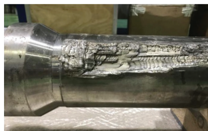
Рис. 3. Повреждение штока арматуры
