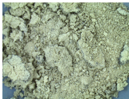
Рис. 1. Порошок \text{HfO}_2 , образованный при испытаниях \varepsilon\text{-HfH}_x (920 °C, 4 часа)
