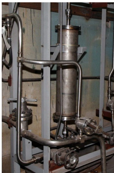
Рис. 4.27. Внешний вид опытных образцов высокоградиентных магнитных фильтров независимо от их типа.
