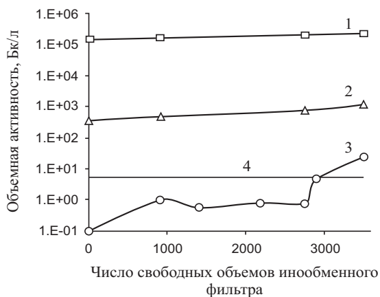
Рис. 5.15. Зависимость суммарной объемной активности \beta -излучающих радионуклидов в ЖРО после предфильтров (1), МОО (2) и после МИО (3) от объема пропущенных ЖРО, (4) — уровень вмешательства по ^{90}\text{Sr}
