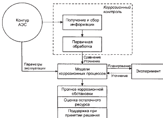
Рис. 3.30. Принципиальная схема коррозионного мониторинга АЭС с ВВЭР-640
