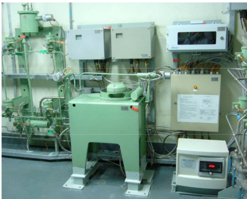
Рис. 2.21. Технологический спектрометр МАРС-012-СУГ для автоматизированного контроля состава и активности радионуклидов в теплоносителе первого контура АЭС.
