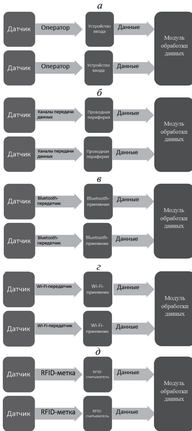
Рис. 3. Схема поступления информации при способах передачи данных: ручном ( а ), по проводу ( б ), с помощью Bluetooth ( в ), Wi-Fi ( г ) и RFID-технологии ( д )
