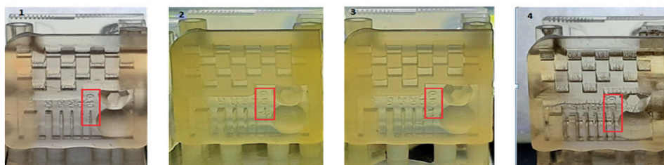
Рисунок 1. Изображения стандартных кубиков, изготовленных методом DLP-печати для оценки детализации
