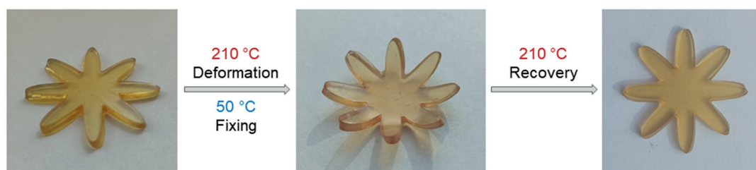
Рисунок 1. Демонстрация эффекта памяти формы на примере структуры, полученной методом LCD 4D-печати.
