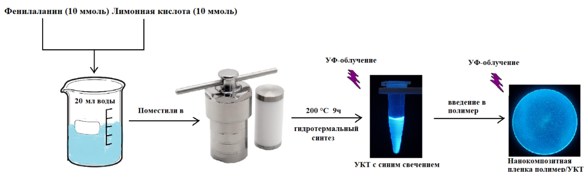
Рис. 1. Схема синтеза углеродных квантовых точек из лимонной кислоты и фенилаланина
