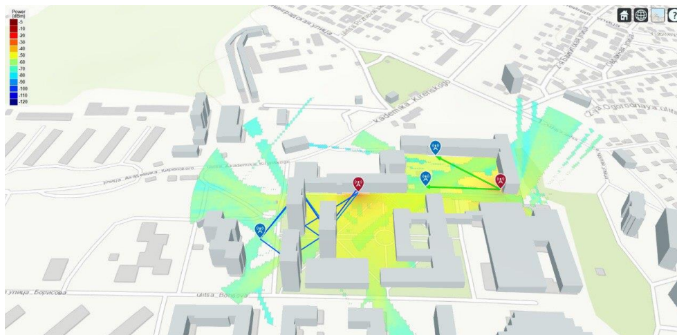
Рисунок 3. Формирование зоны радиопокрытия для двух БС и трех абонентов.
