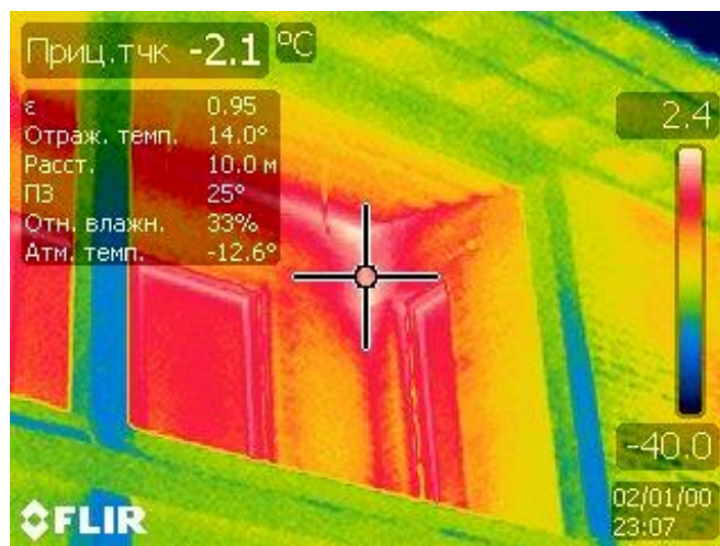
Рисунок. Теплопотери на узле примыкания несущих конструкций
