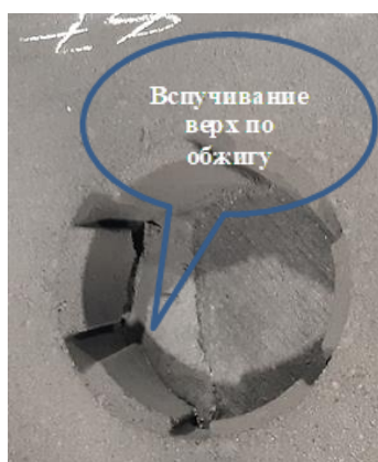
Рисунок 7. Приближенный вид гнезда после чистки. Вспучивание верхней части гнезда по загрузке составляет от 2 до 15мм
