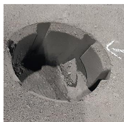
Рисунок 8. Приближенный вид гнезда после чистки. Вспучивание на дне и вырыв части нарезки в НГ
