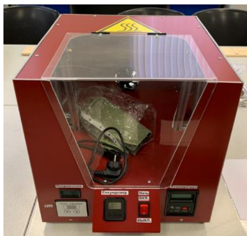
Рисунок 2. Модульная установка для экспресс-оценки огнезащитных свойств текстильных материалов
