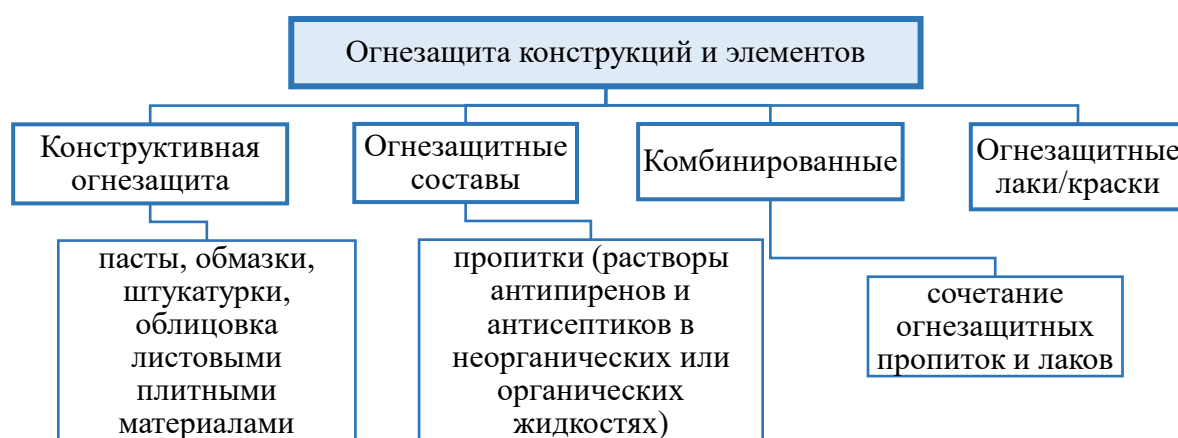
Рисунок. Способы огнезащиты деревянных конструкций и элементов
