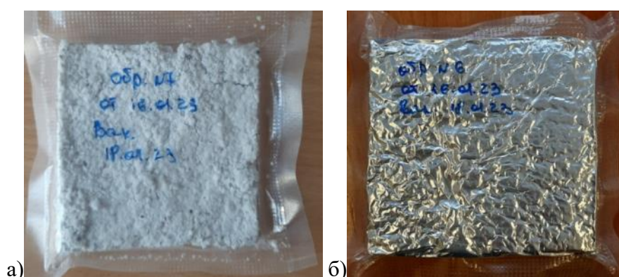
Рисунок 2. Лабораторные образцы вакуумированной плитки утеплителя
