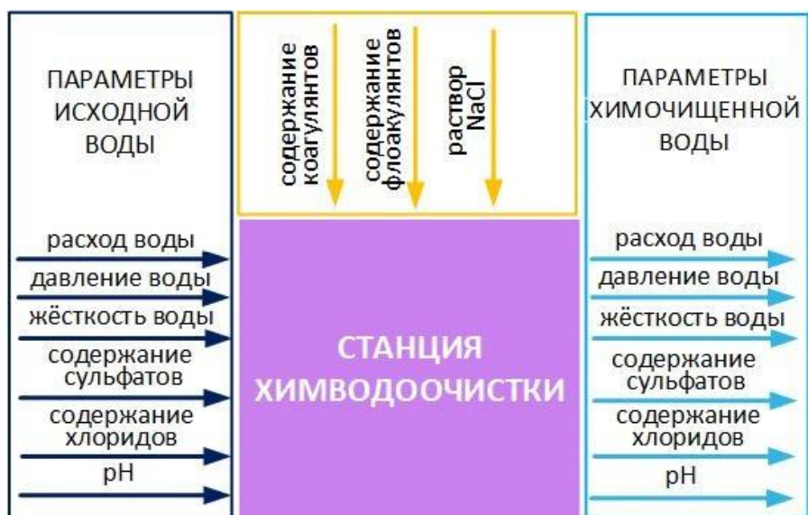
Рисунок. Станция химводоочистки как объект автоматизации.
