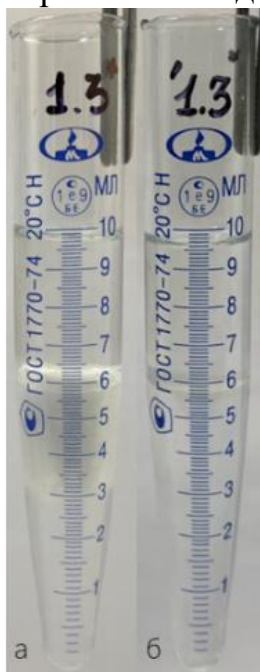
Рисунок 2. Пробирки с товарной формой деэмульгатора и дистиллированной водой: а – с толуолом, б – с нефрасом
