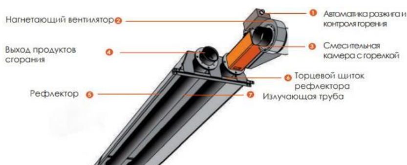
Рисунок 2. Схема ГИИ закрытой конструкции.
