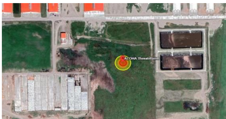
Рисунок 3. Географическая привязка опасных зон для резервуара
