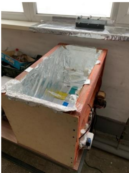
Рисунок 1. Экспериментальная установка модели солнечного излучения
