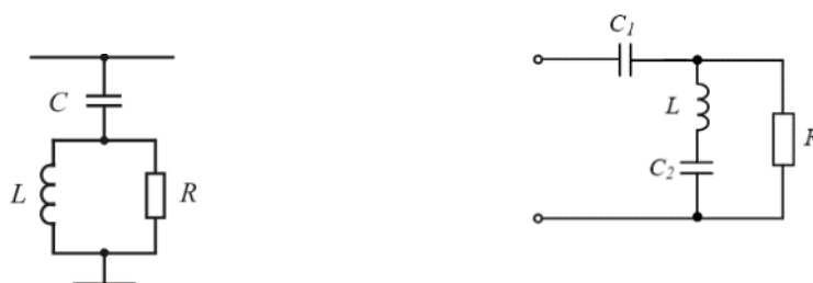
Рисунок 1. Широкополосный фильтр второго порядка и фильтр С-типа
