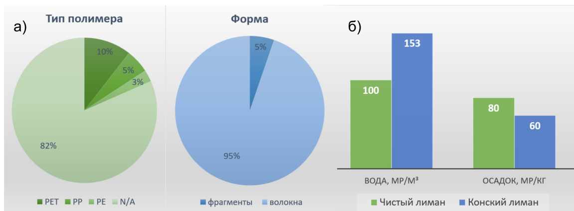
Рисунок 1. Результаты исследования: а) морфологический состав обнаруженных частиц в поверхностной воде по цвету и форме; б) количественное содержание микропластика в пробах воды и донных отложений.
