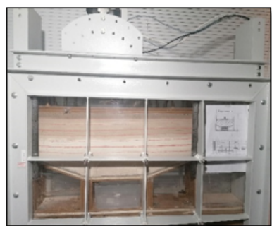
Рис. 1. Внешний вид (А) и схема (Б) устройства для определения суффозионной устойчивости грунтов:
