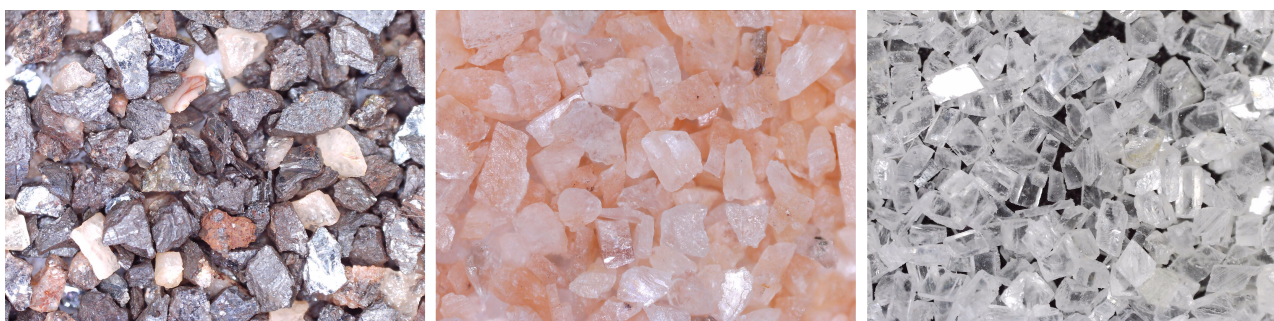
Рисунок 1. Фотографии под микроскопом (слева направо: гематитовый, микроклиновый, кальцитовый. Ширина поля зрения 9 мм).
