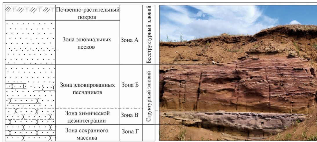
Рисунок 1. Строение профиля выветривания в терригенных обнажениях.
