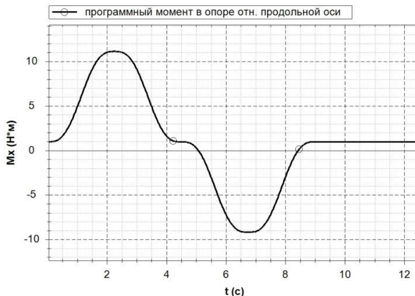
Рис. 2. Программный момент реакции в опоре относительно продольной оси робота
