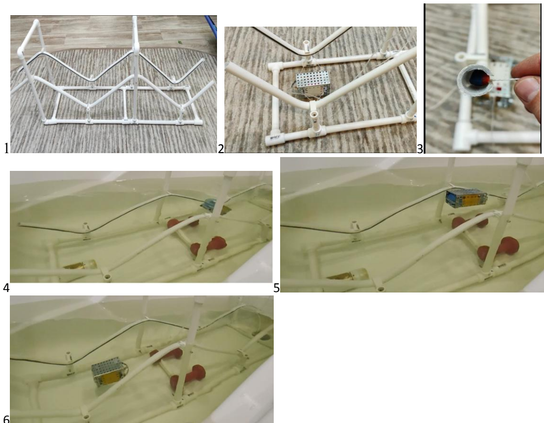
Рис. 5. Модель транспортной системы: 1–3 – конструктивное решение; 4 – шар наполнен воздухом, ПРП всплывает; 5 – переход верхней точки, спускание воздуха; 6 – спуск ПРП
