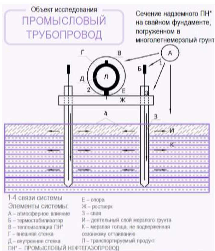
Рис. 1. Система «Трубопровод-ростверк и свая-многолетнемерзлая порода»
