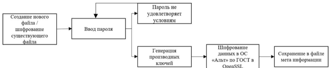
Рис. 1. Схема шифрования файла в Ansible Vault
