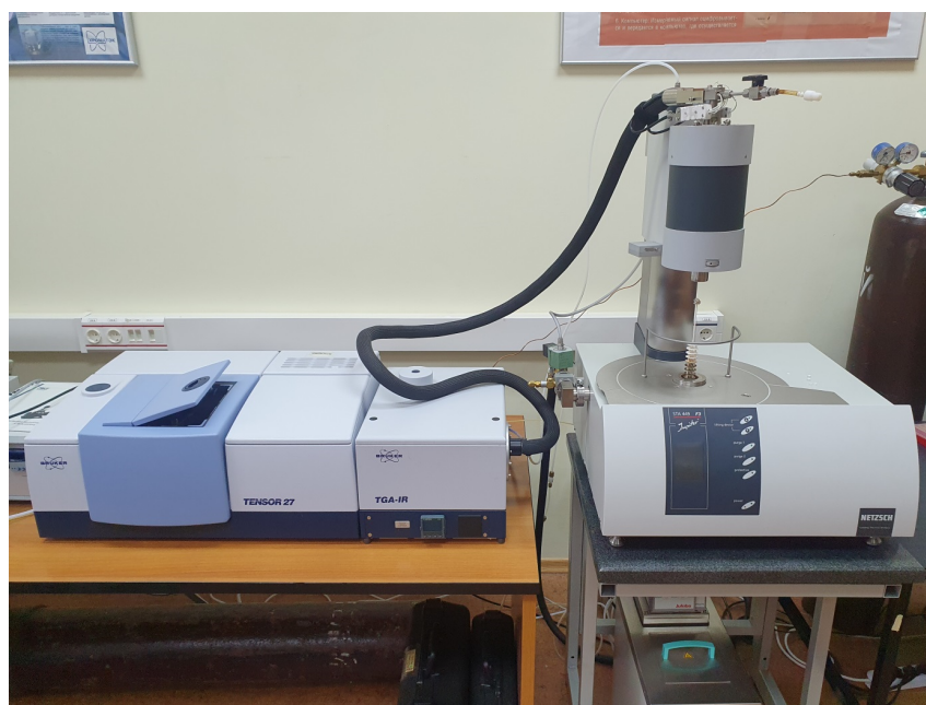
Рисунок 5 – Прибор NETZSCH Jupiter 449 СТА, сопряженный с газовой ячейкой ИК спектрометра Фурье TENSOR 27
