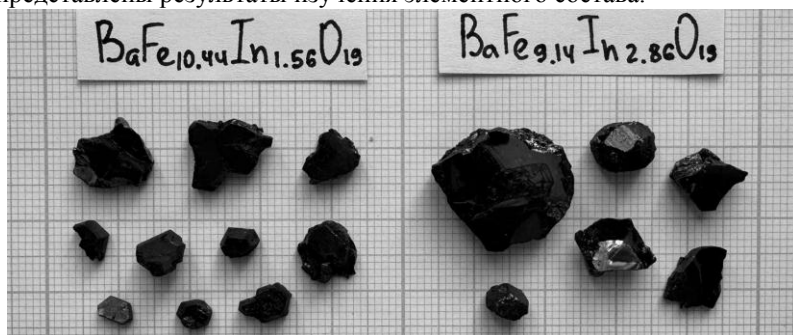
Рис.1. Монокристаллы замещенного индием гексаферрита бария состава BaFe_{10.44}In_{1.56}O_{19} (слева) и BaFe_{9.14}In_{2.86}O_{19} (справа)
