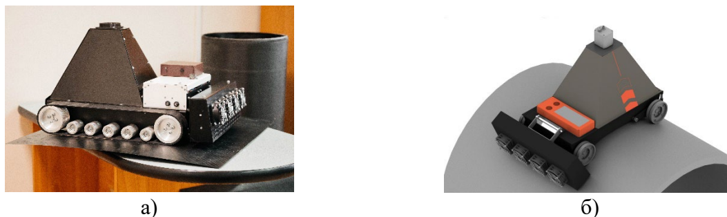
Рис. 2. Самоходные тепловые дефектоскопы для контроля плоских (а) и цилиндрических (б) изделий.
