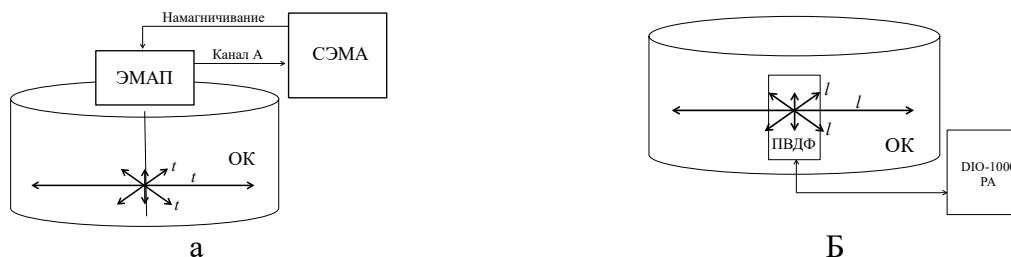
Рис. 1. Направление поляризации поперечной волны (а) и продольной волны (б).
