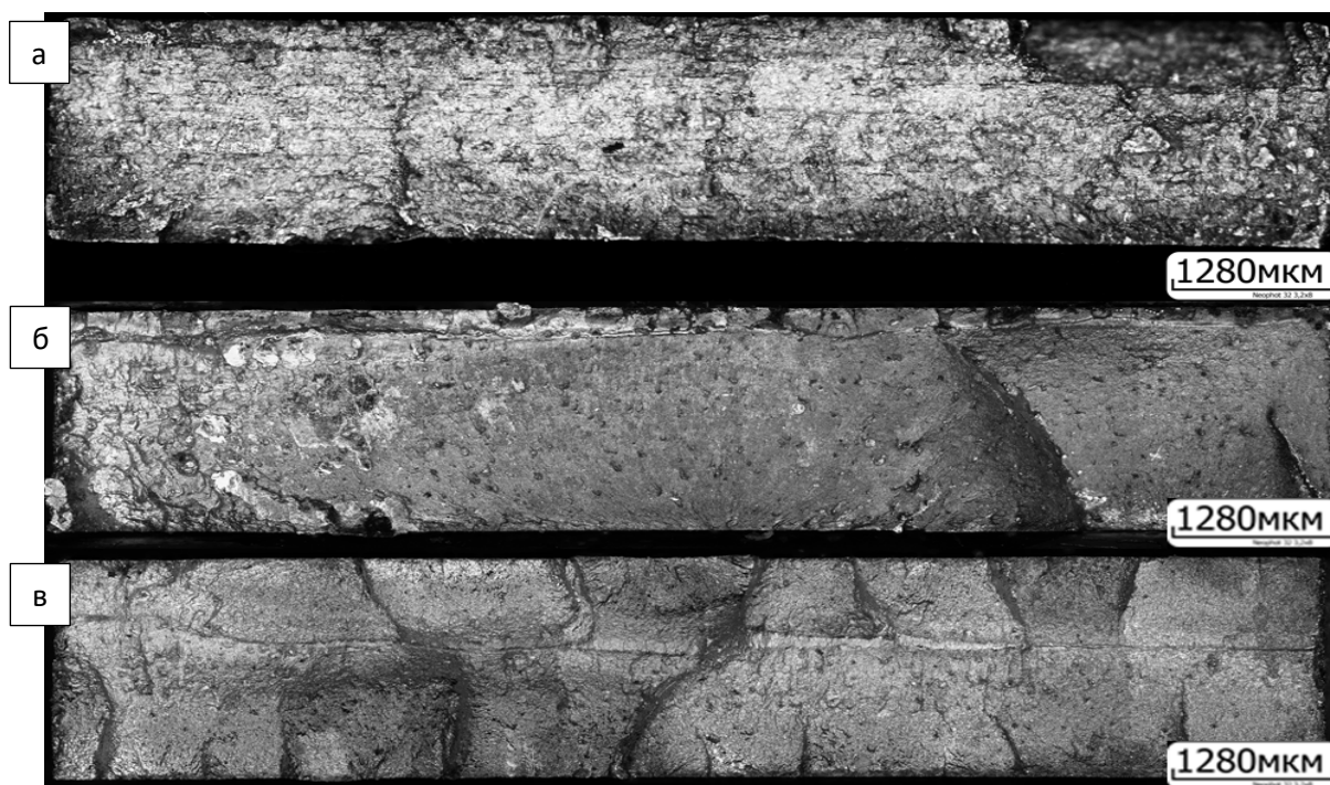
Рис. 1. Оптические изображения изломов образца № 1 (а), образца № 2 (б) и образца № 3 (в), разрушенных от усталости.
