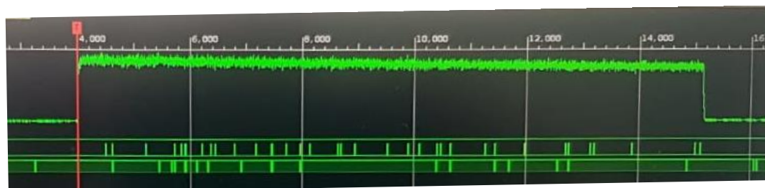
Рисунок 4 – Аналоговый сигнал на выходе ФЭУ при сильном световом импульсе и его измерение в программе управления счетчиком
