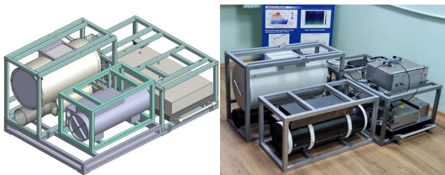
Рисунок 3 – Модель (а) и фотография мобильного лидара для мониторинга парниковых газов в атмосфере ( \text{H}_2\text{O} , \text{CO}_2 , \text{CH}_4 )
