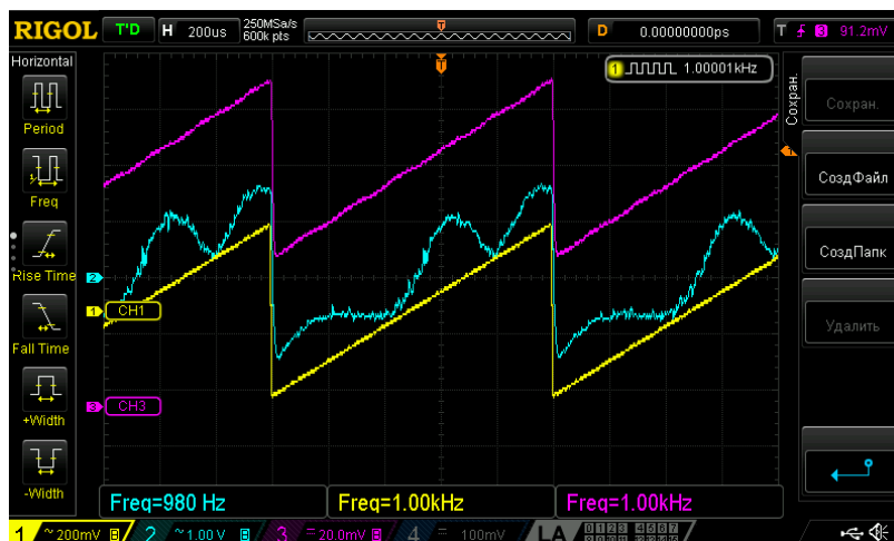
Рисунок 4 – Осциллограммы сигналов модуляции питания лазера (жёлтая и фиолетовая кривые) и зарегистрированные лидарные сигналы (синяя кривая)
