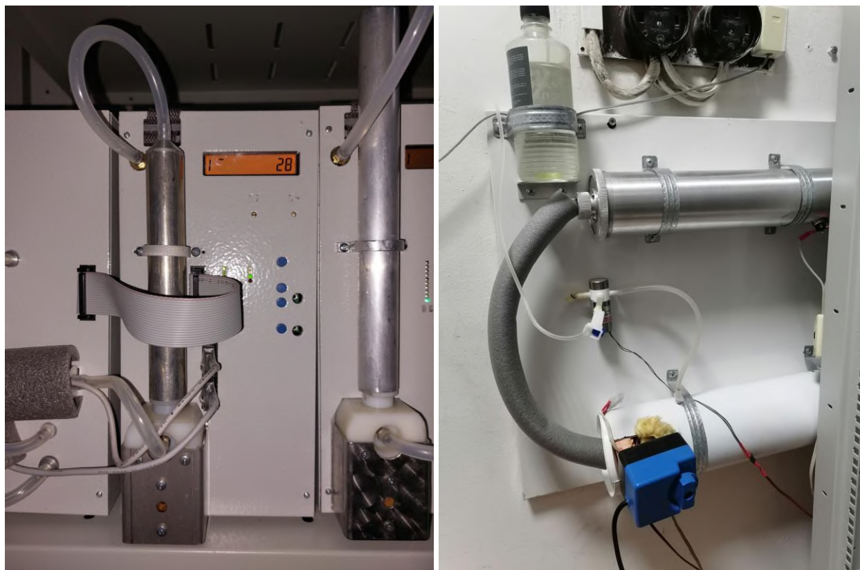
Рисунок 1 – Внешний вид аппаратного комплекса: а) диффузионный спектрометр, б) увлажнитель
