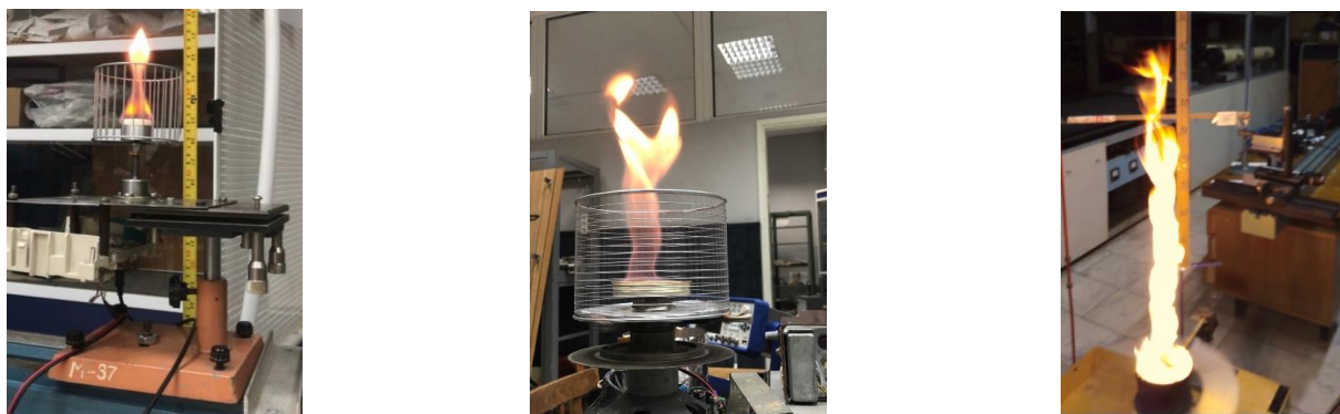
Рисунок 1 – МОС с малой сеткой (слева), со средней сеткой (по центру) и крыльчаткой (справа)
