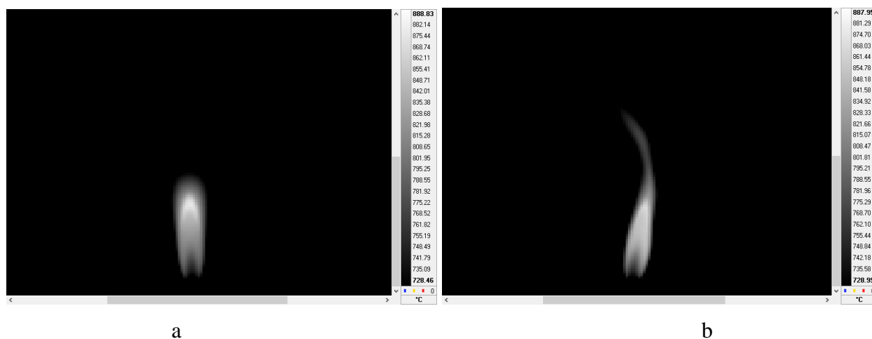
Рисунок 1 – Мгновенная термограмма факела пламени метана без внешних воздействий (а) и при внешнем воздействии пульсаций давления с частотой 5 Гц (b)
