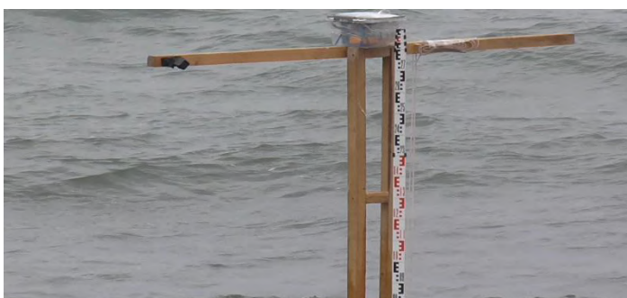
Рисунок 1 – Общий вид измерителя высоты и периода ветровых волн в береговой зоне оз. Байкала, а) и б) вид измерителя крупным планом
