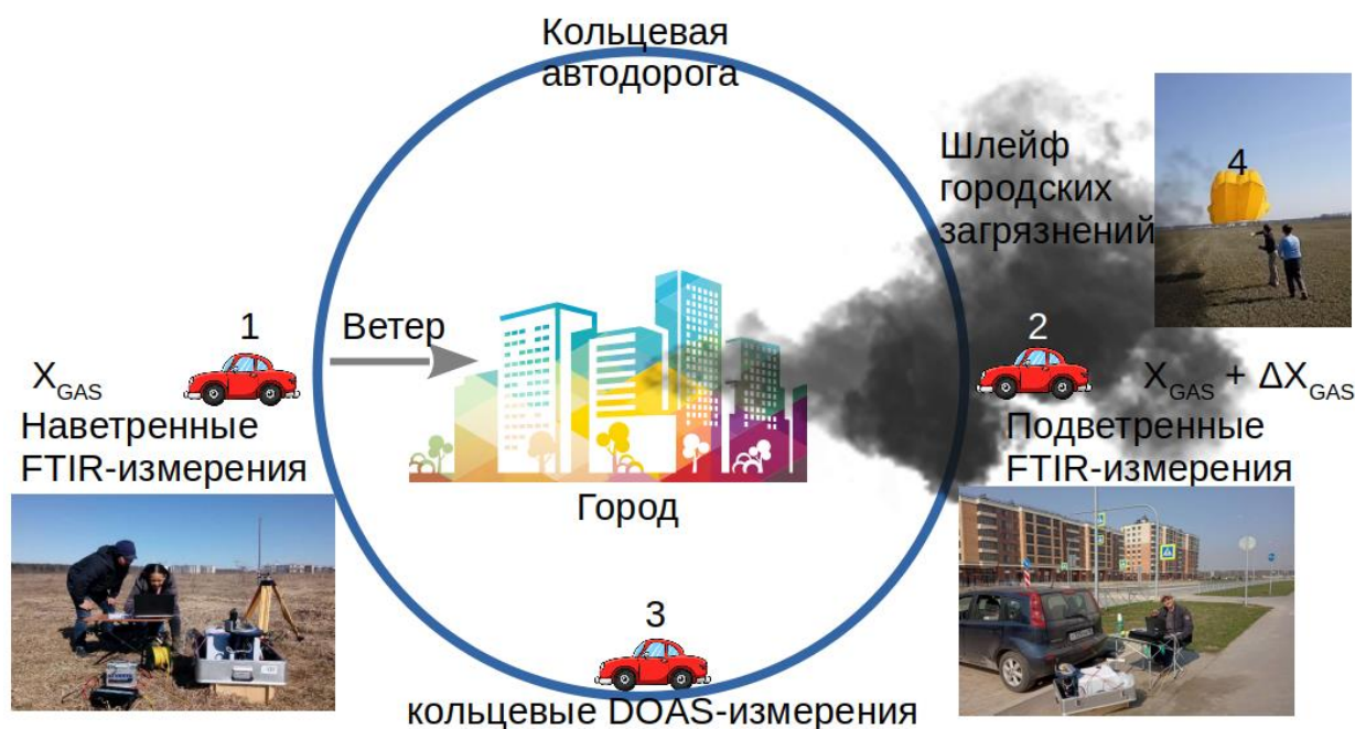
Рисунок 1 – Схема мобильных экспериментов ЕММЕ, где 1 и 2 – FTIR-спектрометры, расположенные с наветренной и подветренной сторон города; 3 – дифракционный спектрометр, осуществляющий DOAS-измерения тропосферного содержания \text{NO}_2 по замкнутому маршруту вдоль КАД; 4 – пробоотбор с помощью воздушного змея (проводился с подветренной стороны при подходящих погодных и ландшафтных условиях). Забор проб воздуха на уровне земли осуществлялся в точках 1 и 2
