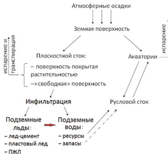
Рис. 1. Цепочка процессов, схематически определяющая условия формирования запасов и ресурсов подземных вод в зоне развития многолетнемерзлых пород
