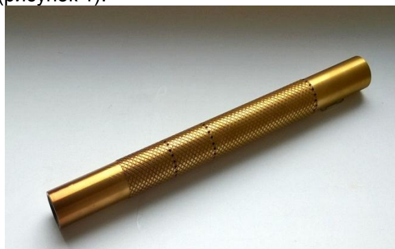
Рисунок 1 – 3D-модель оправки для плетения стентов – а и вид оправки - б
