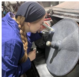
Рисунок 4 – Контроль восстановленного абразивного круга сразу после нанесения покрытия
