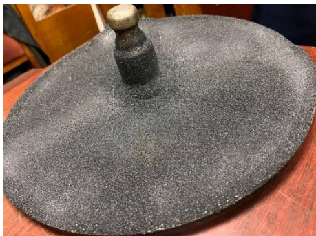
Рисунок 3 – Внешний вид восстановленного абразивного круга
