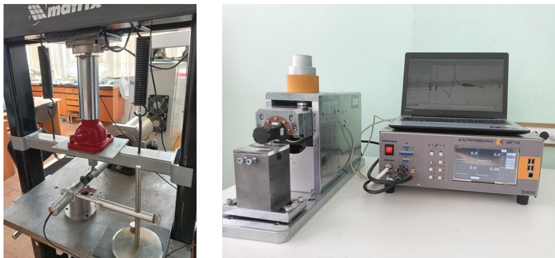
Рисунок 1 – Общий вид установок УЗС: (а) на основе УЗГ-10, (б) УУСМ 6-20
