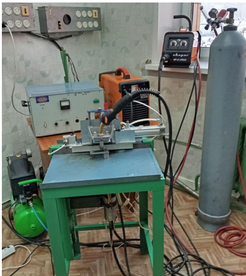
Рисунок 1 – Вид лабораторной установки послойной наплавки методом WAAM с наложением на подложку ультразвуковых колебаний
