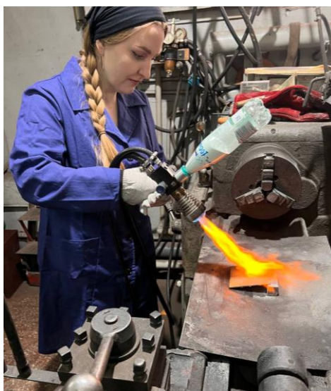
Рисунок 1 – Термораспылитель ОИМ 050 в работе
