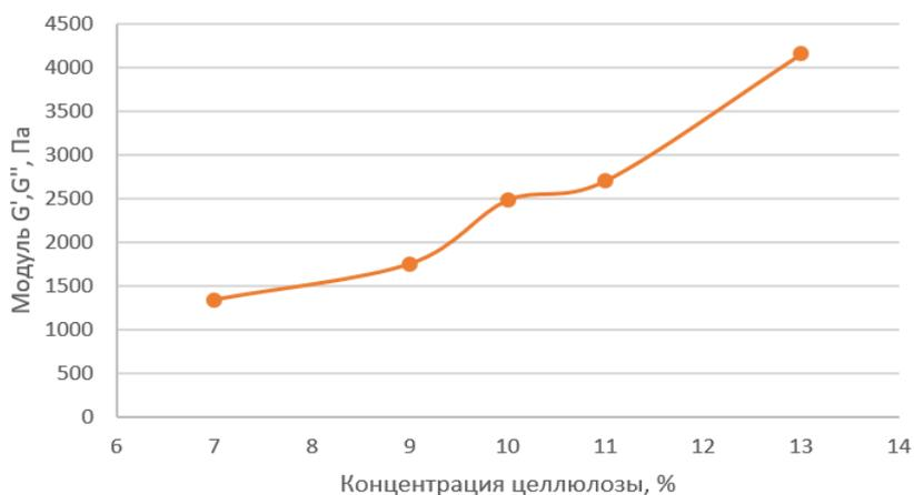
Рис. 1. График зависимости вязкоупругих свойств растворов от концентрации целлюлозы.
