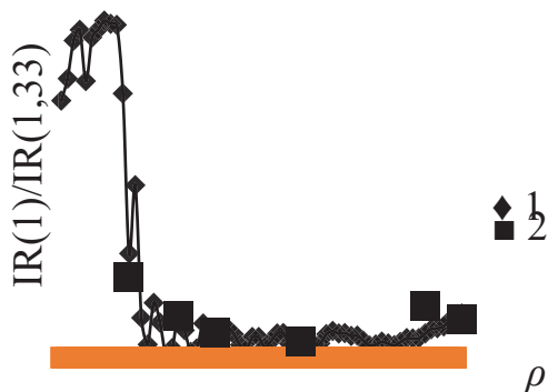
Рисунок 4 – Минимум относительной индикатрисы рассеяния при наличии увлажненного покрытия. Результаты измерений (1) и расчетов (2)
