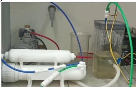
Рис. 1. Модуль системы очистки водных ресурсов электролитно-плазменным методом.
