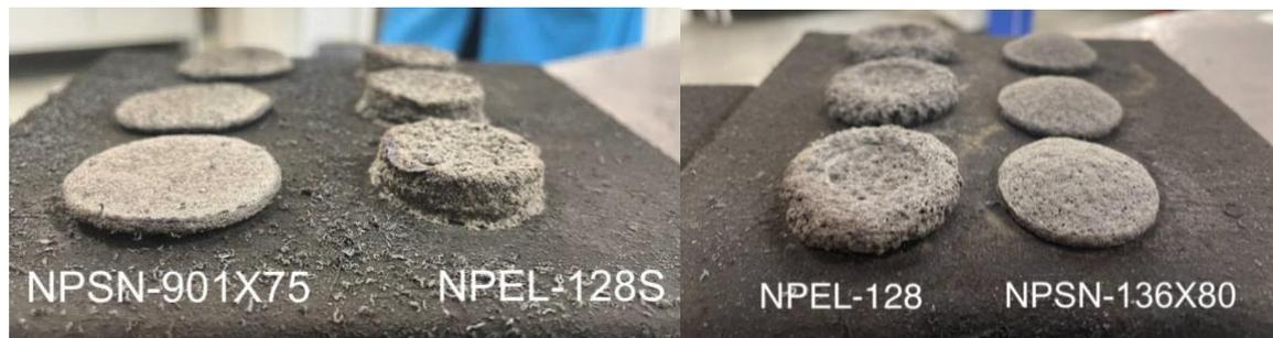
Рис. 1. Внешний вид образовавшегося пенококса
