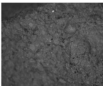
*Рис. 3. Макрофотографии бесполивного гладкого изделия Т0Т-6/23: а (лицевая сторона; обратная сторона с сажей; излом черепка, неоднородная структура)*
