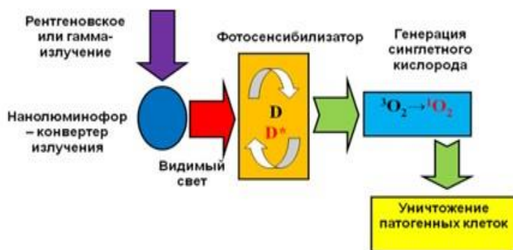
Рисунок 1. Схема усовершенствованной методики ФДТ с использованием фармакологического препарата, включающего фотосенсибилизатор и нанолуминофор – конвертер излучения: D – фотосенсибилизатор; D* – возбужденный фотосенсибилизатор; 3 O 2 – кислород тканей; 1 O 2 – синглетный кислород [3]
