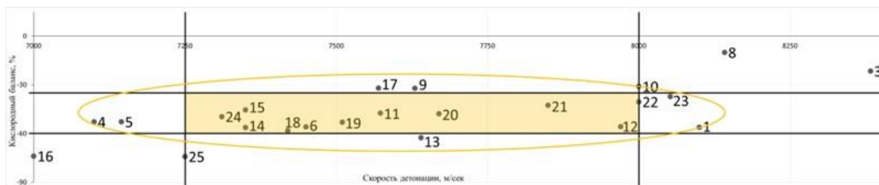
Рисунок 1. Скорость детонации и кислородный баланс ВВ, оптимальных для получения ДНА с выходом \geq 5\% от массы ВВ
