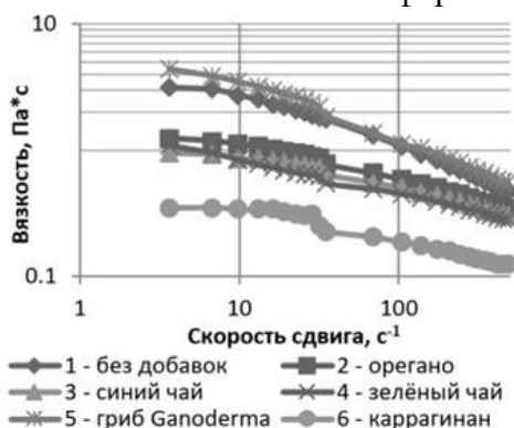
Рисунок 1. Реограммы вязкости 7 % формовочных композиций КК:АН при 333К в двойных логарифмических координатах
