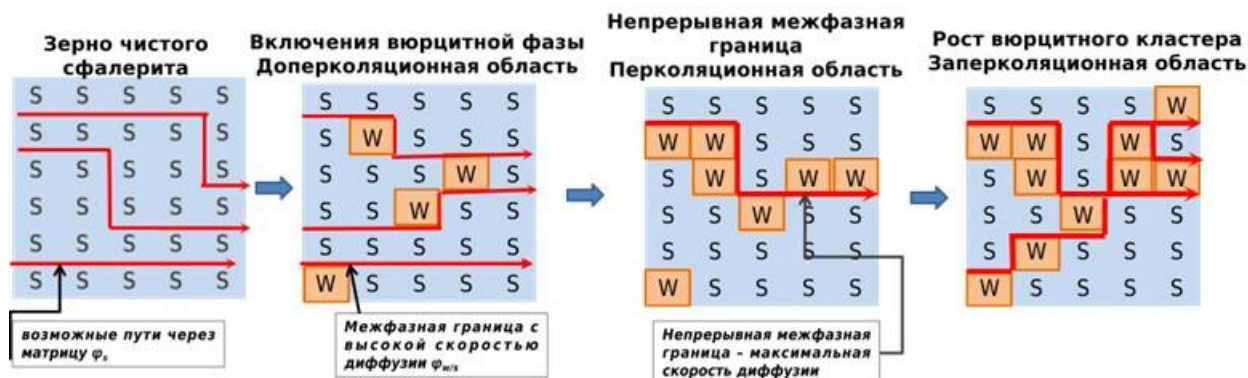
Рисунок 1. Схема образования непрерывной межфазной границы в зерне люминофора
