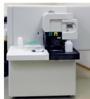
Спектрометр с индуктивно-связанной плазмой Гранд-ИСП
