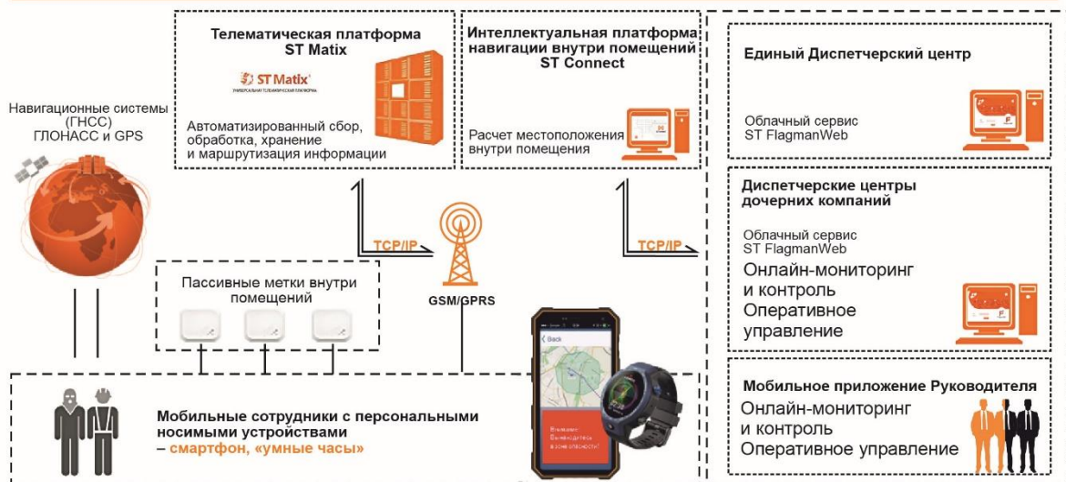
Рисунок 2.4.2 – Схема работы автоматизированной системы мониторинга и контроля персонала, транспортных средств и погрузочной техники вне и внутри помещений на базе интеллектуальной платформы ST Connect. Источник: [10].
