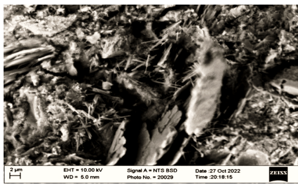
Рис. 1. Рельеф поверхности скола с разных участков КПЦ400-КД с ГД «Фз+Гл», твердевшего 28 сут в нормальных условиях
