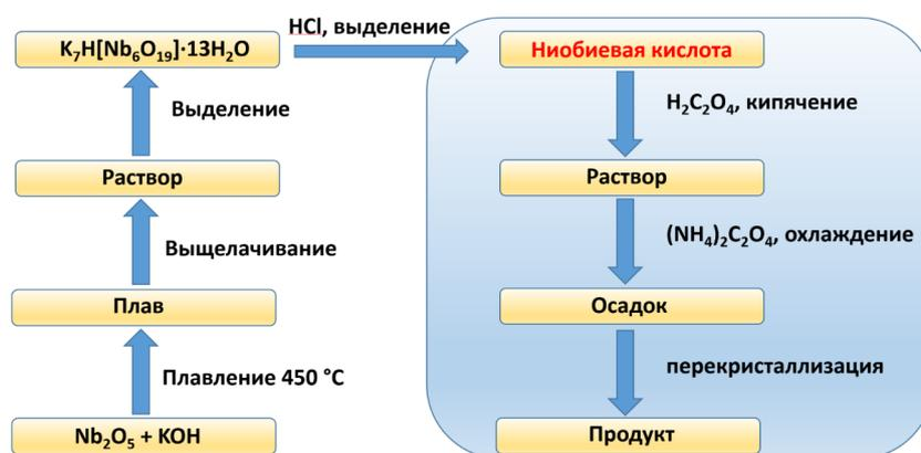
Схема 1. Семистадийный синтез  $(NH_4)[NbO(C_2O_4)_2(H_2O)_2]$
