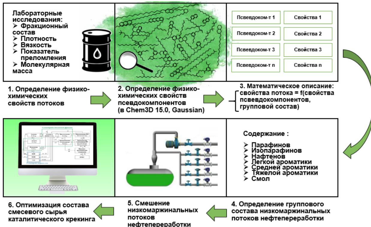
Рис. 1. Блок-схема алгоритма расчетов по оптимизации состава смеси сырьевых каталитического крекинга
