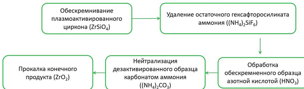
Рис. 1. Схема переработки цирконового концентрата
