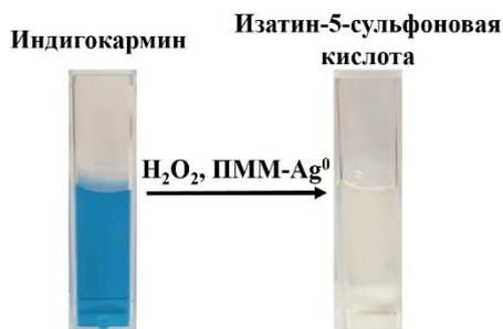
Рис. 1. Окисление индигокармина пероксидом водорода в присутствии ПММ-Ag<sup>0</sup>
