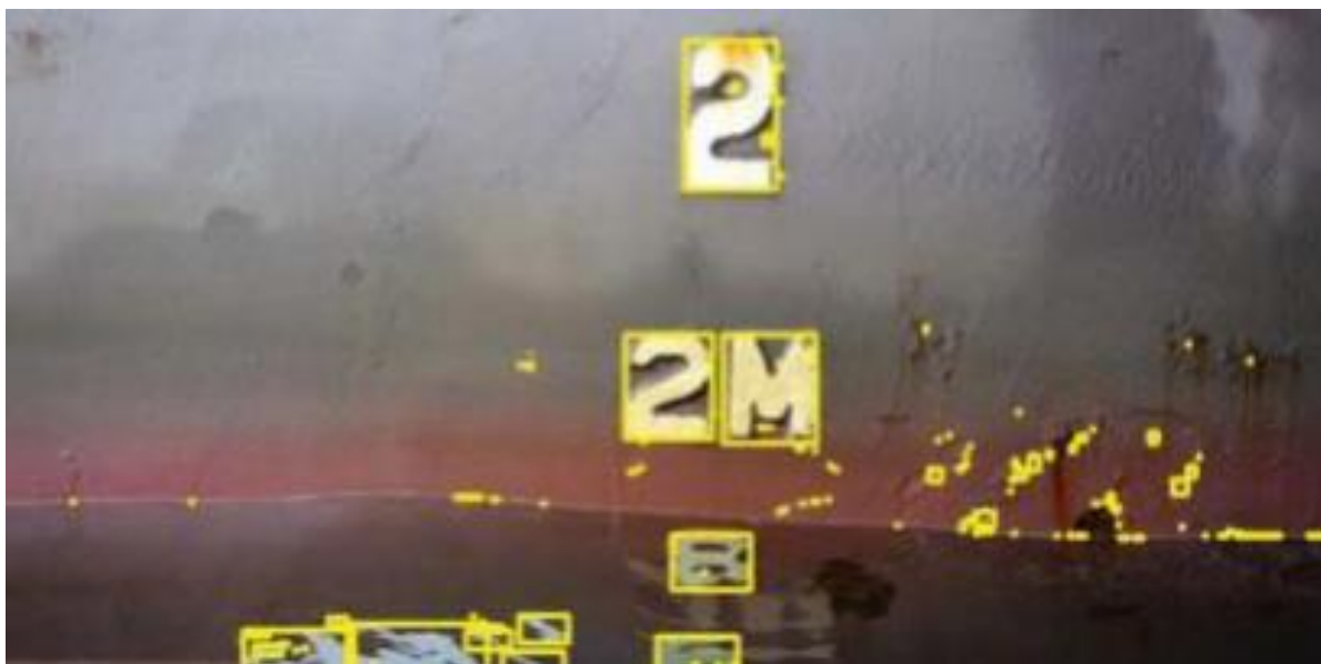
Рисунок 1 – Работа системы компьютерного зрения при определении осадки
