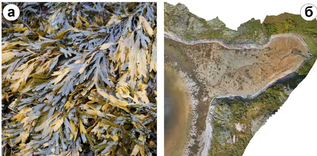
Рис.2. Примеры фрагмента ортофотоплана при разной детализации. Снимки и значения для DJI Mavic Air2S. а) – высота 5 м, GSD = 0.14 см/пикс; б) высота 100 м, GSD = 2.74 см/пикс;
